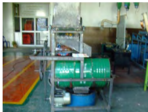
รูปที่ 13 เครื่องย่อยปุ๋ยหมักและเศษใบไม้และผสมปุ๋ย ขนาด 100 ลิตร สามารถย่อยผสม ปุ๋ยหมักและเศษใบไม้ได้ ในอัตราความเร็ว 300 ลิตร ต่อ ชั่วโมง
