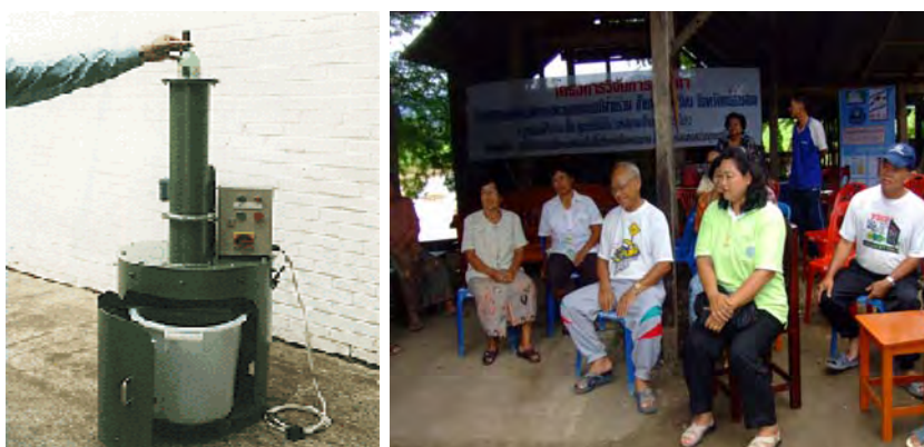
รูปที่ 49 เครื่องย่อยแก้ว ขนาด 50 ลิตร สามารถย่อยผสมขวดแก้วได้ในอัตราความเร็วประมาณ 100 ลิตร ต่อ ชั่วโมง
