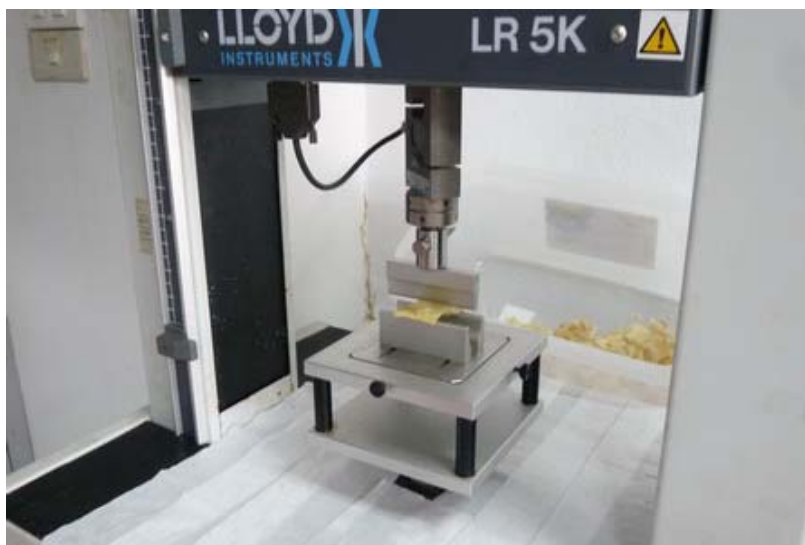
หัววัดแบบ Three Point Bending ของเครื่อง Instron Universal Testing Machine
