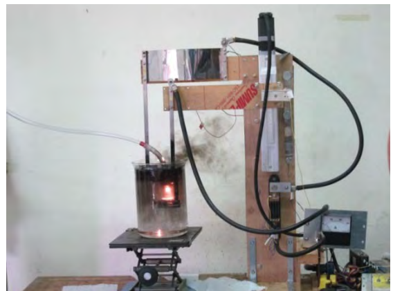
รูปที่ 7.4 การสังเคราะห์วัสดุด้วยวิธี electric arc discharge
