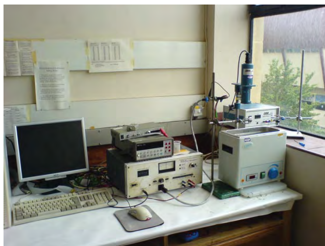
รูปที่ 7.7 การสังเคราะห์วัสดุด้วยวิธี electrodeposition
