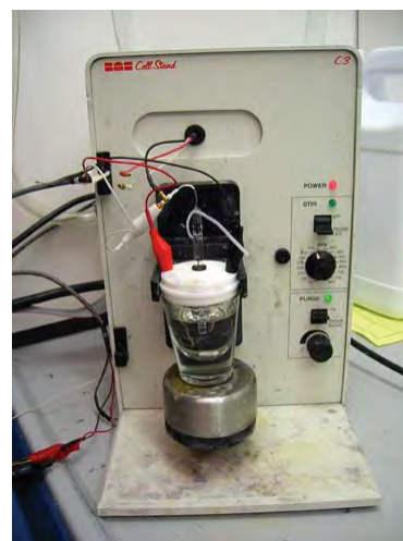
รูปที่ 7.7 การสังเคราะห์วัสดุด้วยวิธี electrodeposition
