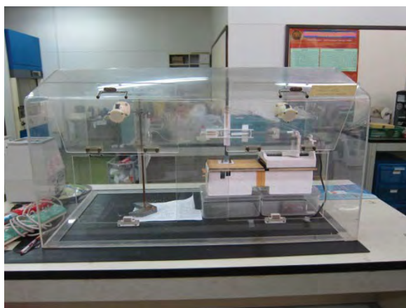
รูปที่ 6.11 ระบบปิดที่มีการนำมาใช้เพื่อป้องกันการได้รับวัสดุนาโนของผู้ปฏิบัติงานในห้องปฏิบัติการนำร่อง
