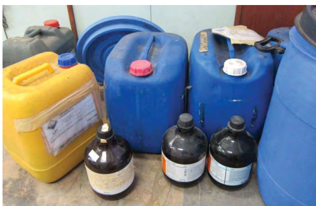
รูปที่ 6.12 การแยกเก็บของเสียวัสดุนาโนออกจากของเสียชนิดอื่น
