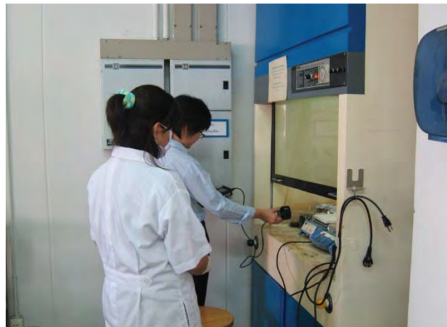
รูปที่ 6.10 การวัดประสิทธิภาพการทำงานของตู้ดูดควันในการทำงานวิจัยด้านนาโนเทคโนโลยี และการให้คำแนะนำกับผู้ปฏิบัติงานในการทำงานให้มีประสิทธิภาพ
