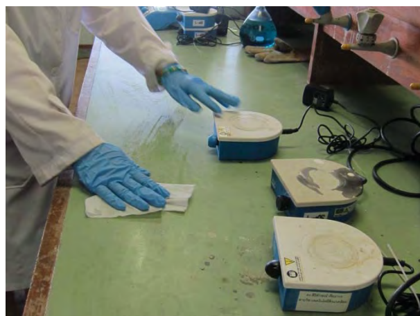
รูปที่ 7.1 การเก็บตัวอย่างจากการเตรียมวัสดุนาโนก่อนการทดลองของห้องปฏิบัติการนำร่อง
