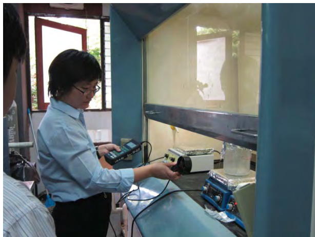
รูปที่ 6.10 การวัดประสิทธิภาพการทำงานของตู้ดูดควันในการทำงานวิจัยด้านนาโนเทคโนโลยี และการให้คำแนะนำกับผู้ปฏิบัติงานในการทำงานให้มีประสิทธิภาพ
