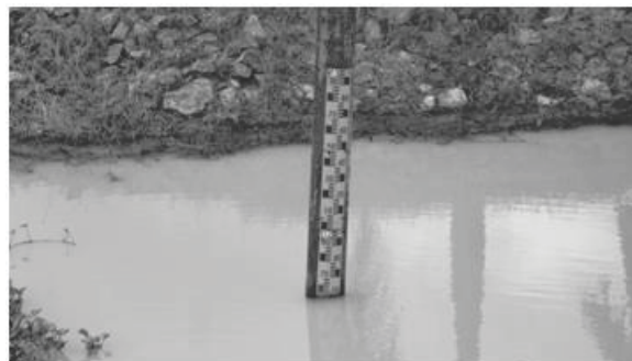
เสาระดับน้ำด้านเหนือน้ำฝายบ้านค่าย จ.ระยอง
