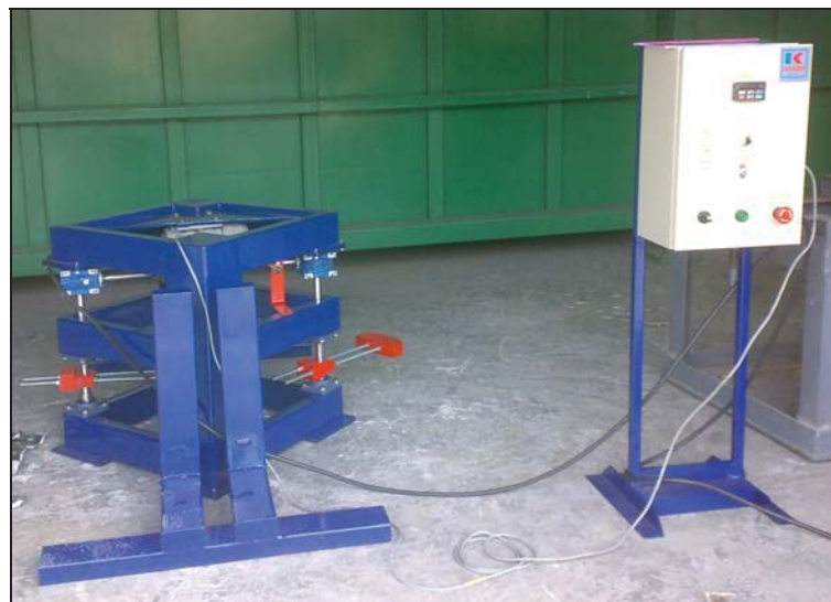
รูปที่ A2.9 ภาพถ่ายของเครื่องเขย่าอาคาร
