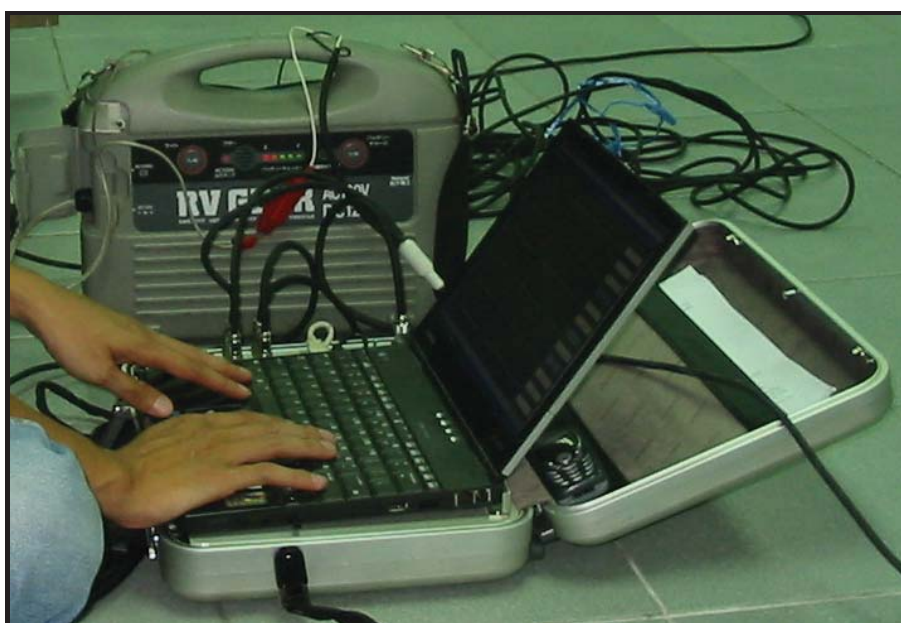
รูปที่ 4.23 อุปกรณ์รับข้อมูล (Data Acquisition Instrument) GEODAS-10-24DS
