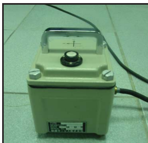
รูปที่ 4.24 หัววัดสัญญาณ (Sensor) CR4.5-2S
