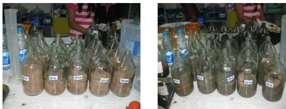
ภาพที่ 4 การเตรียมทะเลาปลาสดและขวดหมักแก๊สชีวภาพจากทะเลาปลาสดเป่าโดยใช้น้ำมูลสุกรเป็นหัวเชื้อเริ่มต้น
