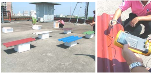
ภาพที่ 1 แสดงสถานที่ทดลอง และการวัดอุณหภูมิโดยใช้เครื่องมือดิจิทัลเทอร์โมมิเตอร์
