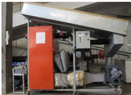
รูปที่ 1 เครื่องอบแห้งที่ใช้พลังงานความร้อนร่วมจากรังสีอินฟราเรดและพลังงานไฟฟ้าเป็นแหล่งพลังงาน
