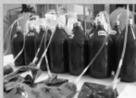
ชุดอุปกรณ์ถังปฏิกรณ์หมักไร้อากาศแบบกะ (batch) ซึ่งประกอบด้วยขวดหมักและถุงเก็บแก๊ส
