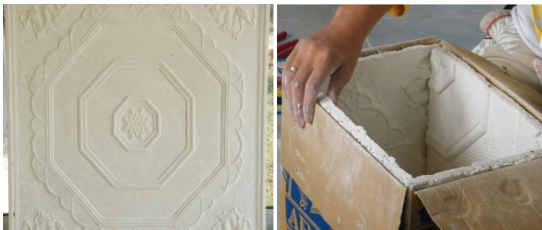
รูปที่ 85 วิธีการทำผ้าเพดานจากแกลบ ศึกษาทดลองคุณสมบัติการป้องกันความร้อน ด้วยการบุข้างลังกระดาษ
