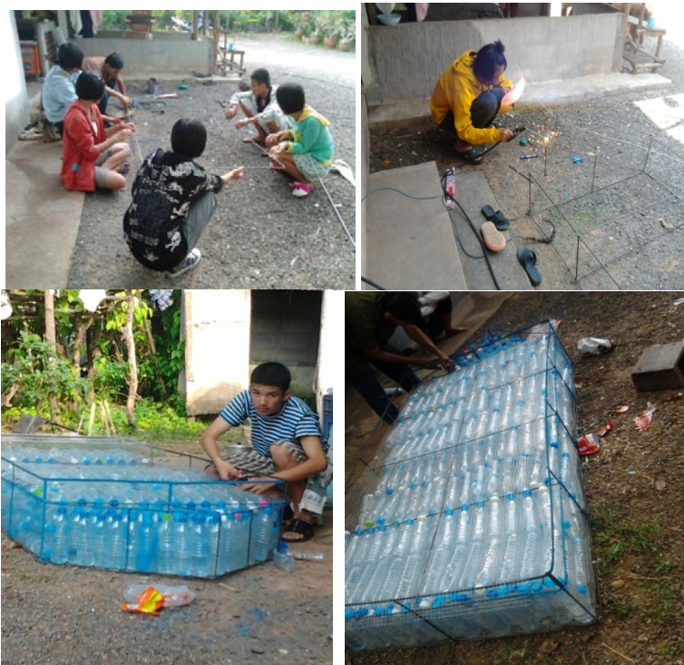
รูปที่ 94 วิธีการทำเรือรีไซเคิลจากขวด
