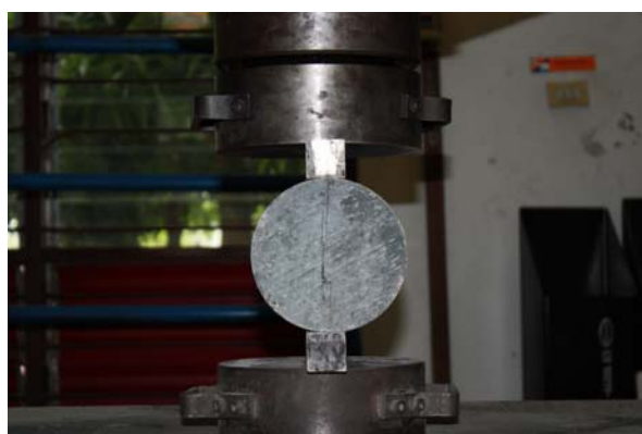
ภาพที่ 3.3 การวางก้อนตัวอย่างในแนวนอนใต้หัวกดสำหรับทดสอบแรงดึง
