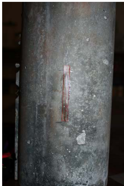
(ค) ติดตั้ง Stain Gauge กับก้อนตัวอย่าง
