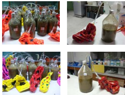
รูปที่ 1 ชุดทดลองการผลิตก๊าซชีวภาพจากการหมักใบยางพาราและใบยางพาราร่วมกับเศษวัชพืช โดยใช้น้ำมูลสุกรเป็นหัวเชื้อเริ่มต้น
