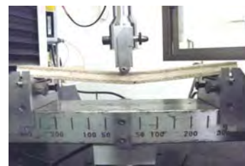
รูปที่ 3 การทดสอบโมดูลัสยืดหยุ่นและโมดูลัสการแตกหัก
