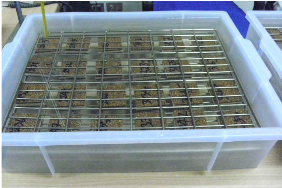
รูปที่ 4 การทดสอบการดูดซับน้ำและการฟองตัว
