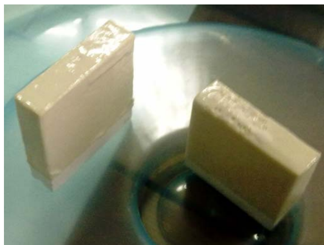
รูปที่ 4 การนำแบบพิมพ์พลาสติกที่ไม่มีสารช่วยจับตัว (Coagulant) จุ่มลงในน้ำยางข้น
