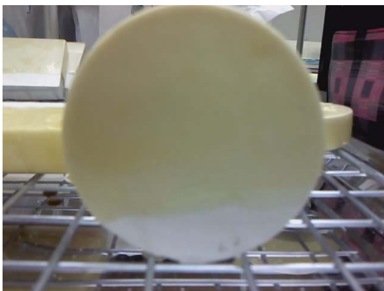
รูปที่ 6 การจับตัวของน้ำยางชั้นบนผิวแบบพิมพ์พลาสติกที่เคลือบด้วยเจลเปียกแคลเซียมซิลิเกต
