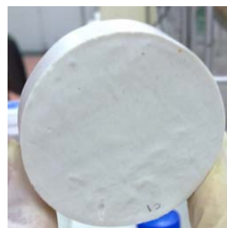
รูปที่ 6 การจับตัวของน้ำยางชั้นบนผิวแบบพิมพ์พลาสติกที่เคลือบด้วยเจลเปียกแคลเซียมซิลิเกต
