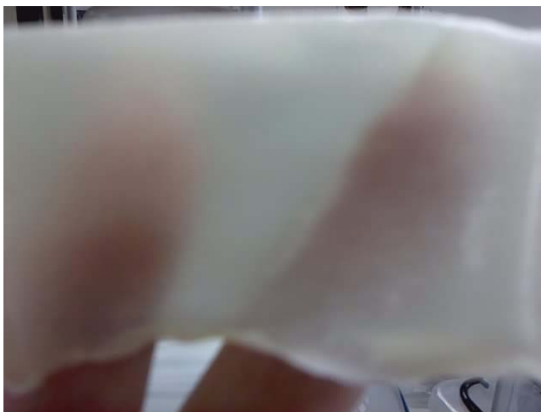
รูปที่ 9 ฟิล์มยางที่ได้จากแบบพิมพ์พลาสติกเตอร์ที่จุ่มเคลือบด้วยเจลเปียกแคลเซียมซิลิเกตนาน 1 นาที
