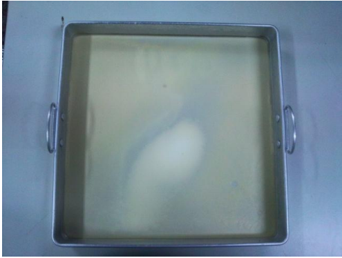
รูปที่ ก2 ลักษณะของแผ่นฟิล์มคอมพอสิตของยางธรรมชาติ และคาโบลินด์หลังการอบแห้งในตู้อบสุญญากาศ
