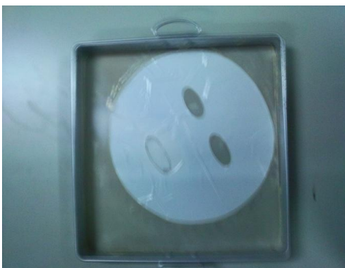
รูปที่ ก5 ลอกส่วนของแผ่นฟิล์มคอมพอสิตที่ไม่ใช้ออกจากถาด
