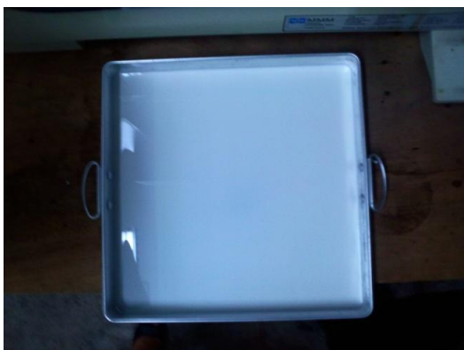
รูปที่ ก1 ของผสมของน้ำยางธรรมชาติ คาโพลิไนด์ PEG และกลีเซอรอลในถาดขึ้นรูปก่อนนำเข้าตู้อบสูญญากาศ
