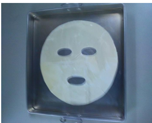
รูปที่ ก7 แผ่นพอกหน้าหลังจากลอกออกจกถาดและผลิต ก้านที่เป็นแผ่นฟิล์มคอมพอสิตขึ้น
