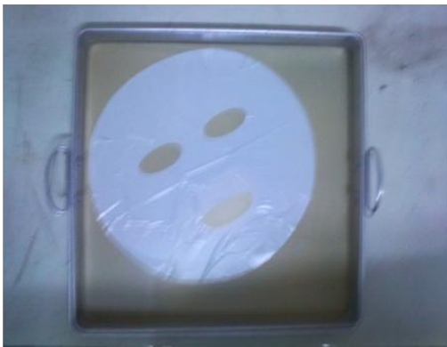
รูปที่ ก3 ทาบแบบแผ่นพอกหน้าขนาดเท่าใบหน้าคนลงบนแผ่นฟิล์มคอมพอสิต
