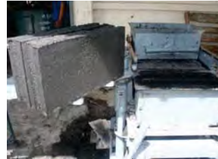
รูปที่ 1 คอนกรีตบล็อกเถ้าแกลบผสมยางวัลคาไนซ์ที่ขึ้นรูปด้วยเครื่องอัดไฮโดรลิก
