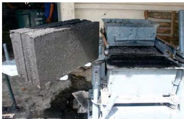
รูปที่ 2 ตัวอย่างคอนกรีตบล็อกเก่าแก่กลับที่ได้จากการขึ้นรูปด้วยเครื่องอัดไฮโดรลิก
