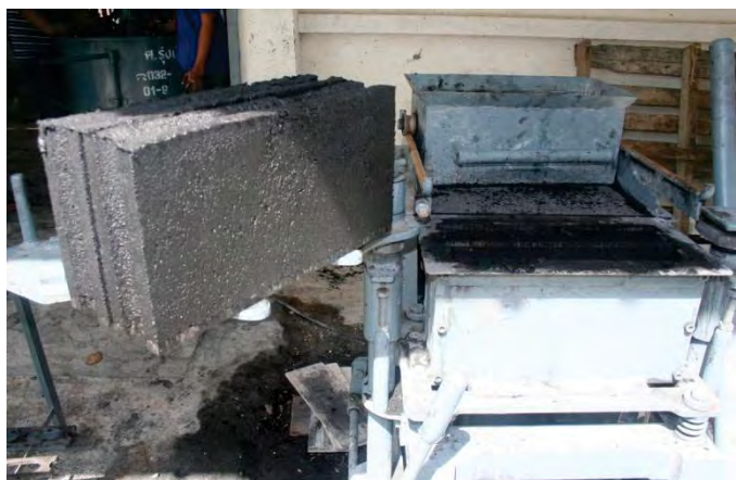
รูปที่ 7 ตัวอย่างคอนกรีตบล็อกเถ้าแกลบที่ได้จากการขึ้นรูปด้วยเครื่องอัดไฮโดรลิก
