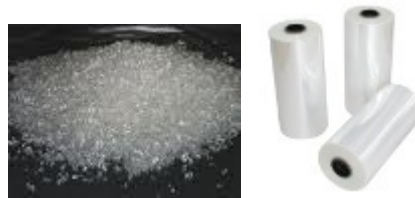
รูปที่ 1.2 ลักษณะเม็ดและแผ่นฟิล์มของพอลิแล็กติกแอซิด [3]
