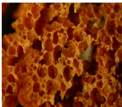
รูปที่ 23 ลักษณะโครงสร้างเซลล์ของฟองน้ำยางธรรมชาติที่เติมสาร mPDA-P และเติม SSF ที่ระดับ 1.2 phr(กำลังขยาย x4)
