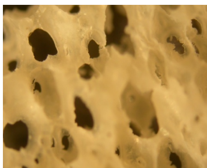
รูปที่ 27 ลักษณะโครงสร้างเซลล์ของฟองน้ำยางธรรมชาติเมื่อเติม DPG ที่ระดับ 0.7 phr เมื่อใช้ APP ที่ระดับ 40 phr (กำลังขยาย x4)
