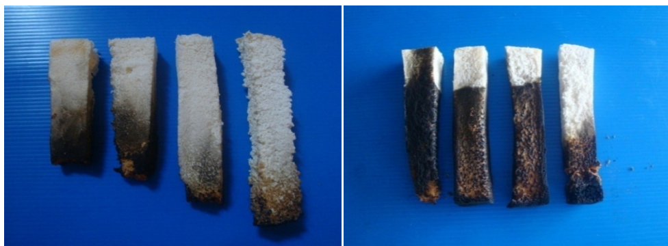
รูปที่ 30 ลักษณะของฟองน้ำยางธรรมชาติทนไฟ หลังทดสอบการเผาไฟเมื่อเติมปริมาณ ATH ที่ระดับ 50, 100, 120 และ 150 phr โดยเรียงจากซ้ายไปขวา
