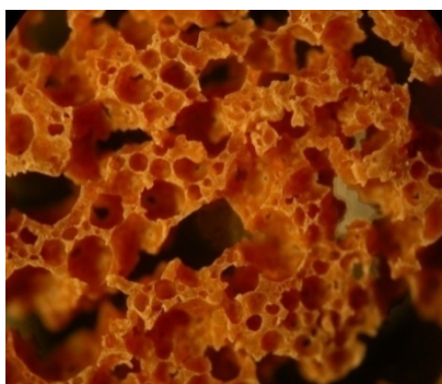
รูปที่ 13 ลักษณะโครงสร้างเซลล์ของฟองน้ำยางธรรมชาติเมื่อเติม mPDA-P ที่ 37 phr (กำลังขยาย x4)
