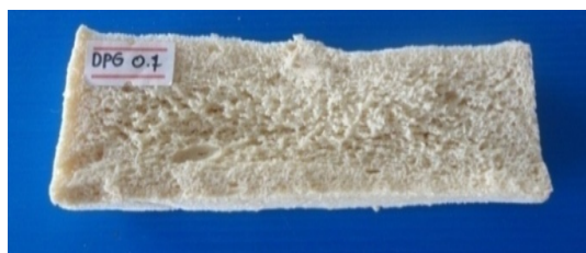
รูปที่ 24 ลักษณะของฟองน้ำยางธรรมชาติทนไฟเมื่อใช้สาร APP ที่ระดับ 40 phr และเติมสารก่อเจลเสริม DPG ที่ระดับ 0.7 phr
