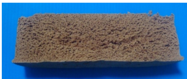
รูปที่ 26 ลักษณะของฟองน้ำยางธรรมชาติทนไฟเมื่อใช้สาร mPDA-P ที่ระดับ 37 phr และเมื่อเติมสารก่อเจลเสริม DPG ที่ระดับ 1.2 phr
