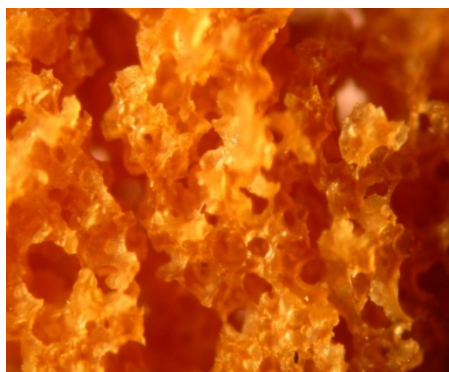
รูปที่ 29 ลักษณะโครงสร้างเซลล์ของฟองน้ำยางธรรมชาติเมื่อเติม DPG ที่ระดับ 0.7 phr เมื่อใช้ mPDA-P ที่ระดับ 37 phr (กำลังขยาย x4)
