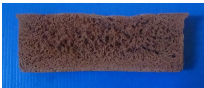
รูปที่ 20 ลักษณะของฟองน้ำยางธรรมชาติทนไฟเมื่อเติมสารก่อเจลหลัก SSF ที่ระดับต่าง ๆ เมื่อใช้ mPDA-P ที่ระดับ 37 phr และใช้ SSF ที่ระดับ 1.2 phr
