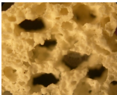
รูปที่ 12 ลักษณะโครงสร้างเซลล์ของฟองน้ำยางธรรมชาติเมื่อเติม ที่ 35 phr (กำลังขยาย x4)
