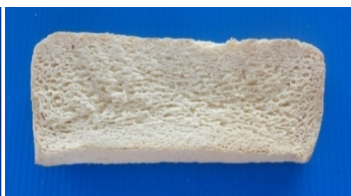
รูปที่ 19 ลักษณะของฟองน้ำยางธรรมชาติทนไฟเมื่อเติมสารก่อเจลหลัก SSF ที่ระดับต่าง ๆ เมื่อใช้ MPP ที่ระดับ 35phr และใช้ SSF ที่ระดับ 1.2 phr
