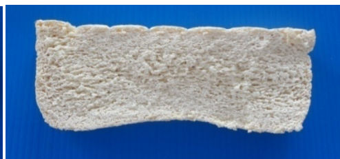
รูปที่ 25 ลักษณะของฟองน้ำยางธรรมชาติทนไฟเมื่อใช้สาร MPP ที่ระดับ 35 phr และเมื่อเติมสารก่อเจลเสริม DPG ที่ระดับ 1.2 phr
