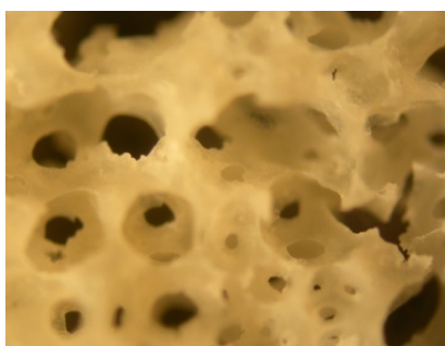
รูปที่ 21 ลักษณะโครงสร้างเซลล์ของฟองน้ำยางธรรมชาติที่เติมสาร APP และเติม SSF ที่ระดับ 1.2 phr (กำลังขยาย x4)
