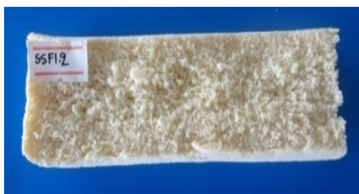
รูปที่ 18 ลักษณะของฟองน้ำยางธรรมชาติทนไฟเมื่อเติมสารก่อเจลหลัก SSF ที่ระดับต่าง ๆ เมื่อใช้ APP ที่ระดับ 40 phr และใช้ SSF ที่ระดับ 1.2 phr
