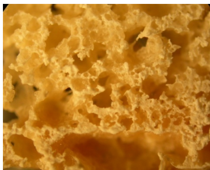
รูปที่ 22 ลักษณะโครงสร้างเซลล์ของฟองน้ำยางธรรมชาติที่เติมสาร MPP และเติม SSF ที่ระดับ 1.2 phr (กำลังขยาย x4)
