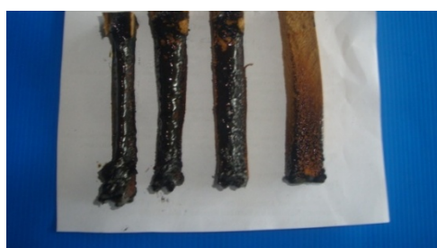
รูปที่ 15 ลักษณะของฟองน้ำยางธรรมชาติทนไฟเมื่อเติมปริมาณ MPP ที่ระดับ 25, 30, 35 และ 37 phr เรียงจากซ้ายไปขวาหลังการทดสอบการเผาไฟ
