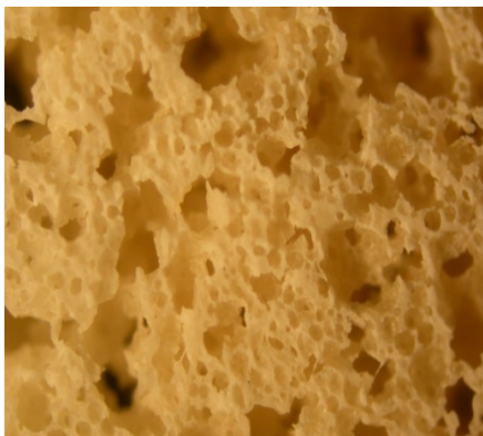
รูปที่ 28 ลักษณะโครงสร้างเซลล์ของฟองน้ำยางธรรมชาติเมื่อเติม DPG ที่ระดับ 0.7 phr เมื่อใช้ MPP ที่ระดับ 35 phr (กำลังขยาย x4)
