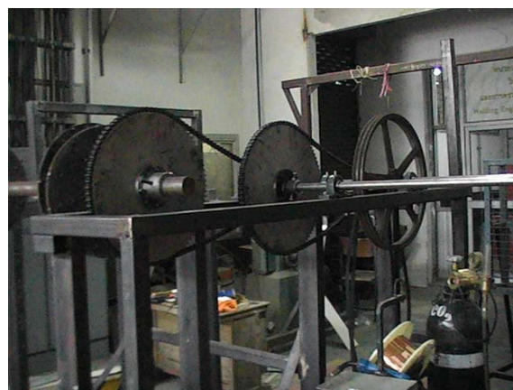
รูปที่ 196 ติดตั้งระบบเฟืองโซ่ทดสำหรับส่งกำลังไปหมุนเจนเนอเรเตอร์
