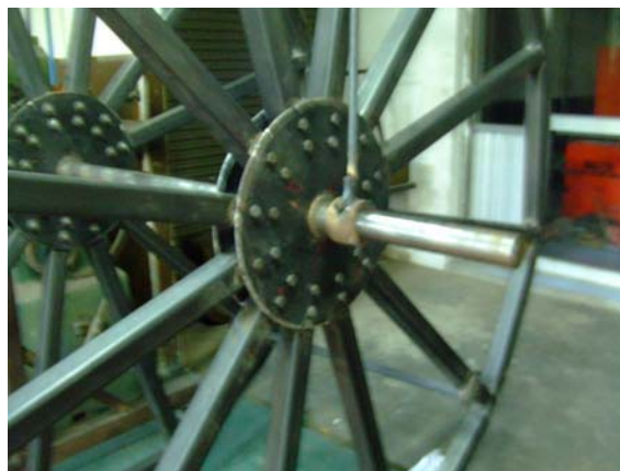
รูปที่ 190 การยึดโครงถอดประกอบจาก Bolt และ Nut จำนวนมาก
