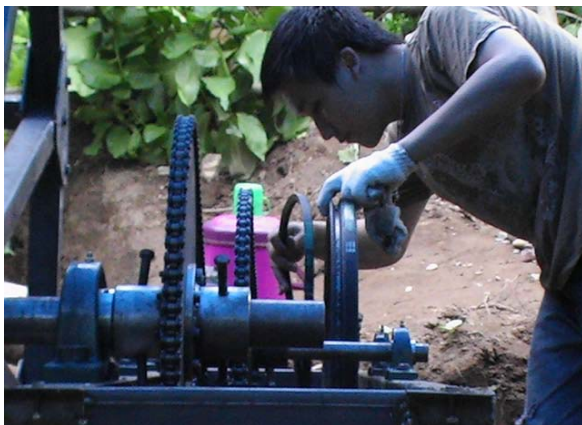
รูปที่ 217 ผู้ช่วยนักวิจัยติดตั้งสายพานขับเคลื่อนมอเตอร์
