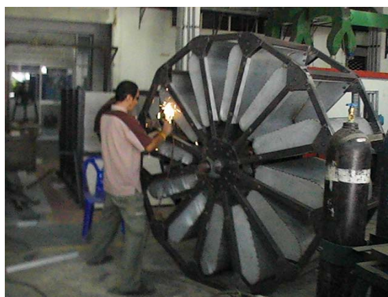
รูปที่ 192 ผู้ช่วยนักวิจัยกำลังดำเนินการเชื่อม ตะเข็บรอยต่อ Bucket ของวงล้อน้ำ
