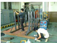
รูปที่ 29 ผู้ช่วยนักวิจัย ประกอบวงล้อน้ำและฐาน ตามแบบ ในห้องทดลอง มหาวิทยาลัยเทคโนโลยีราชมงคลธัญบุรี เขตพื้นที่ภาคพายัพ เชียงใหม่
