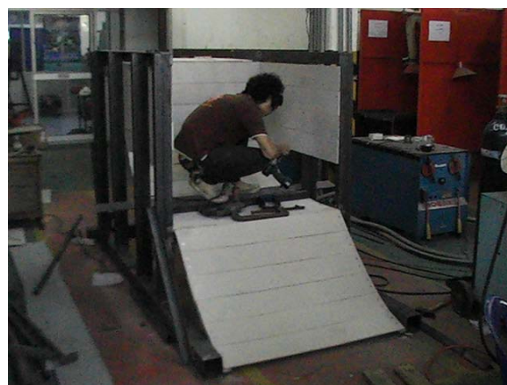
รูปที่ 194 ผู้ช่วยนักวิจัยประกอบแผ่นไม้เซอร่าบริเวณห้องรับน้ำ
