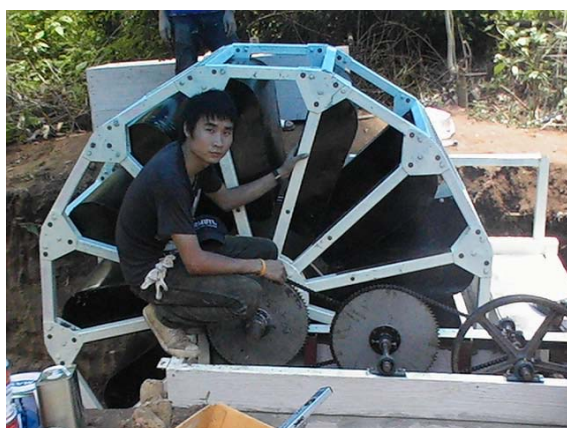
รูปที่ 223 ปรับตั้งชุดเฟืองโซ่และสายพานส่งกำลัง
