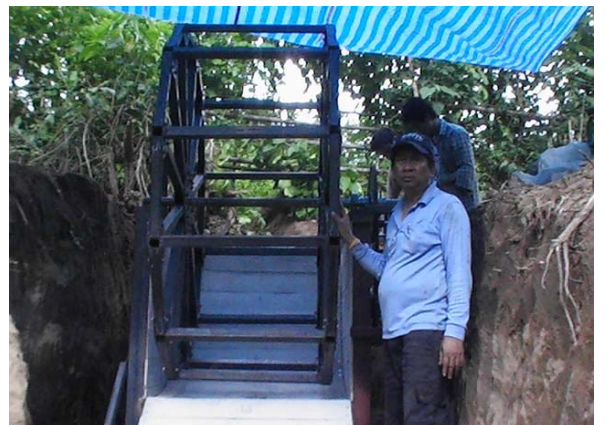
รูปที่ 218 ประกอบแผ่นไม้เซอร์ราติดกับโครงฐานวงล้อน้ำ
