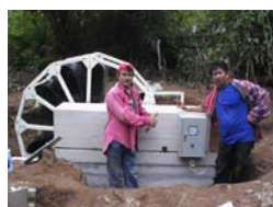
รูปที่ 37 วงล้อน้ำที่สำเร็จเรียบร้อย และมอบให้ผู้ช่วย ผู้ใหญ่บ้านห้วยโป่ง และสมาชิก อบต.เสาหิน ประสาน อบต.เสาหินเพื่อดำเนินการเชื่อมต่อสายส่ง เข้าหมู่บ้านใช้ งานกับระบบแสงสว่างต่อไป
