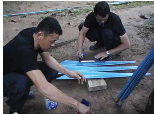
กำลังพลปฏิบัติการขึ้นรูปใบพัดกังหันลม ด้วยตนเอง
