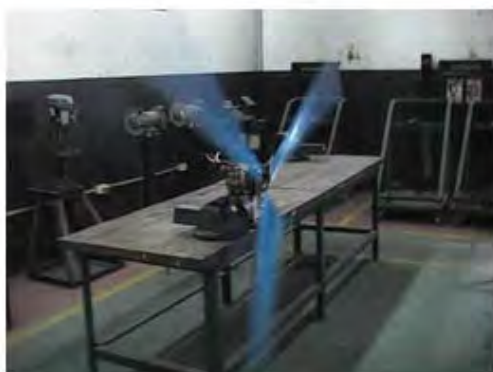
ประกอบใบพัดและทดสอบการหมุนของใบพัด ใบพัดเริ่มหมุนที่ความเร็วลม 4 m/sec
