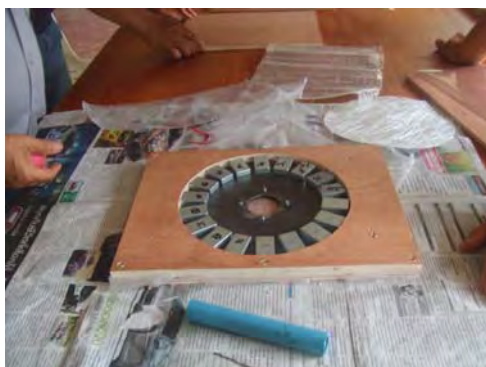
กำลังพลฝึกทักษะออกแบบวางตำแหน่ง แม่เหล็กถาวรในแบบเตรียมหล่อเรซิน
