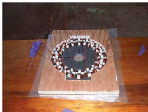
กำลังพลฝึกทักษะออกแบบวางตำแหน่ง ขด ลวดในแบบเตรียมหล่อเรซิน
