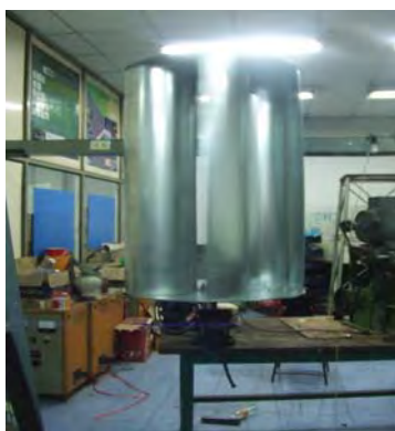
กังหันลมแนวตั้งที่ประกอบเรียบร้อยแล้วทดลอง หมุนด้วยลมจำลอง
