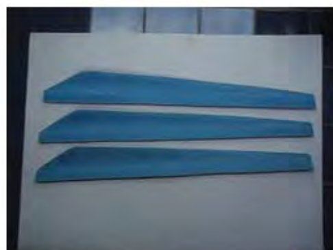
คุมยึดใบพัด และใบกังหันลมที่ทำจากท่อ PVC
