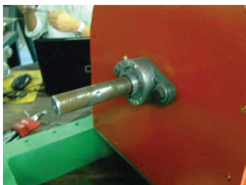
ฝึกการประกอบเพลากังหันกังหันน้ำผลิต ไฟฟ้าชนิด Pelton Turbine กับ เครื่องกำเนิด ไฟฟ้า
