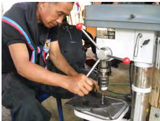
กำลังพล ฝึกสร้างงานจริง เจาะชิ้นส่วนฐาน กึ่งหันลม
