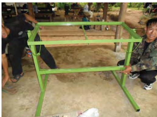
ประกอบโครงรองรับแผงโซลาเซลล์ หลังจากเคลือบสี
