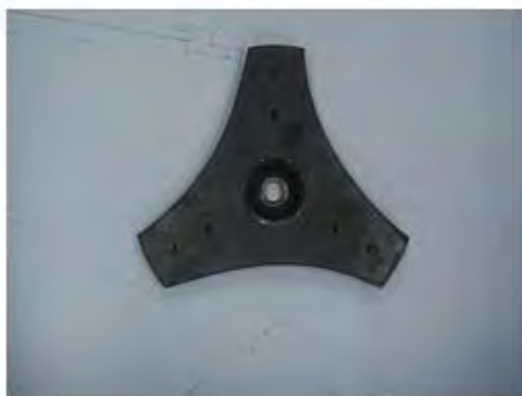
คุมยึดใบพัด และใบกังหันลมที่ทำจากท่อ PVC
