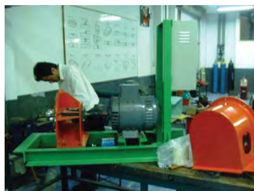
ฝึกการเคลื่อนย้ายกังหันกังหันน้ำผลิตไฟฟ้า ชนิด Pelton Turbine และประกอบชิ้น สุดท้าย
