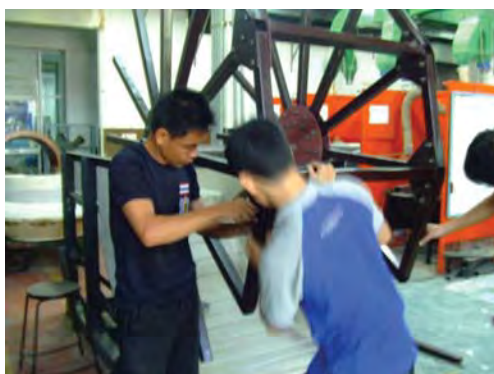
กำลังพลฝึกรอบรม จก.ทพ.36 การประกอบอุปกรณ์วงล้อ กังหันน้ำผลิตไฟฟ้าชนิดลื่อน้ำ
