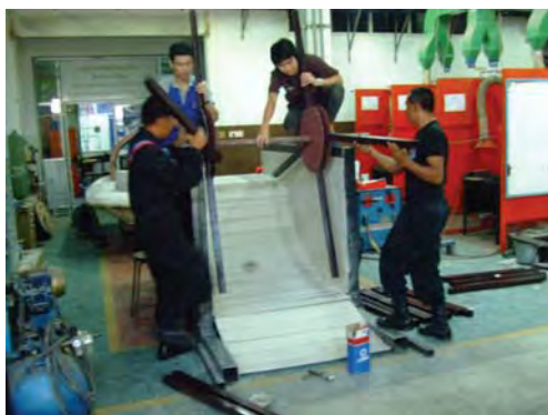
กำลังพลฝึกรอบรม จก.ทพ.36 การสร้างฐานรองรับกังหันน้ำผลิตไฟฟ้าชนิดลื่อน้ำ
