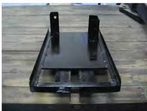
แท่นลำนัดงักหน้ลมสำหรับรอรบรับชุดเครื่องกำเนดไฟฟา
