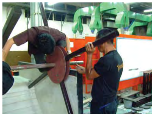
กำลังพลฝึกรอบรม จก.ทพ.36 การประกอบกล่องอุปกรณ์ กังหันน้ำผลิตไฟฟ้าชนิดลื่อน้ำ
