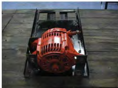
แท่นลำนัดงักหน้ลมสำหรับรอรบรับชุดเครื่องกำเนดไฟฟา
