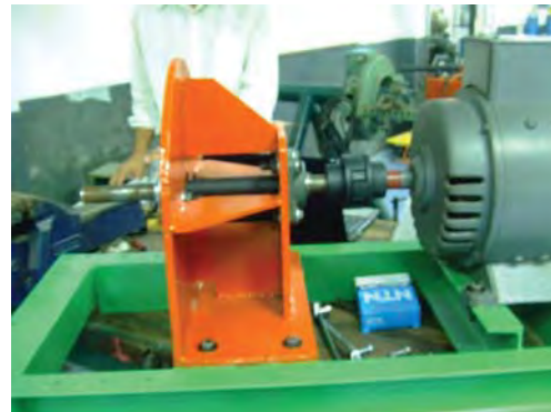
ฝึกการสร้างโครงลำตัวกังหันกังหันน้ำผลิต ไฟฟ้าชนิด Pelton Turbine
