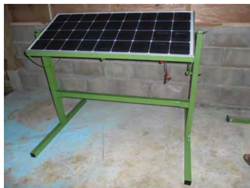
ประกอบโครงรองรับแผงโซลาเซลล์กับแผ่น โซลาเซลล์เตรียมใช้งาน
