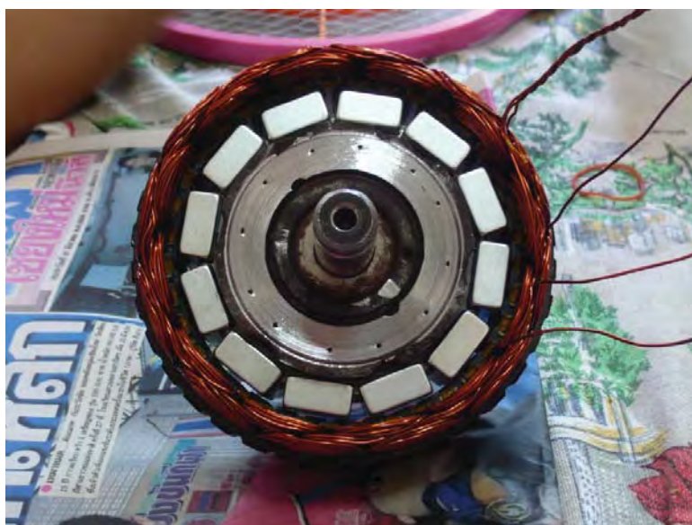
รูปที่ 5 อัลเตอร์เนเตอร์ปรับแต่งแล้ว
