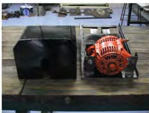
ประกอบฝาดรอบกับแท่นลำนัดงักหน้ลมสำหรับรอรบรับชุดเครื่องกำเนดไฟฟา
