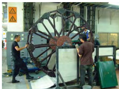
โครงกังหันน้ำผลิตไฟฟ้าชนิดลื่อน้ำถูกประกอบ เรียบร้อยแล้ว
