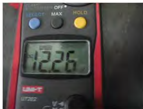
ทดลองให้เครื่องกำเนิดไฟฟ้าหมุนที่ 550 รอบต่อนาที
