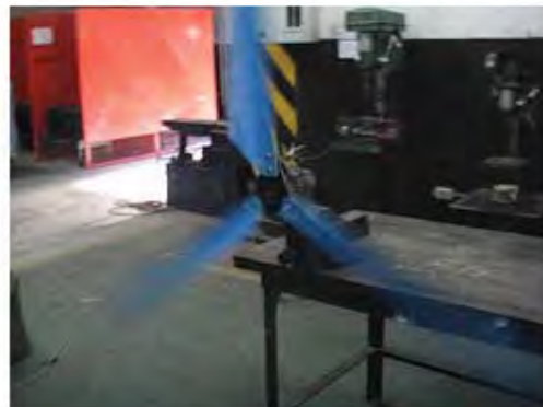
ประกอบใบพัดและทดสอบการหมุนของใบพัด ใบพัดเริ่มหมุนที่ความเร็วลม 4 m/sec
