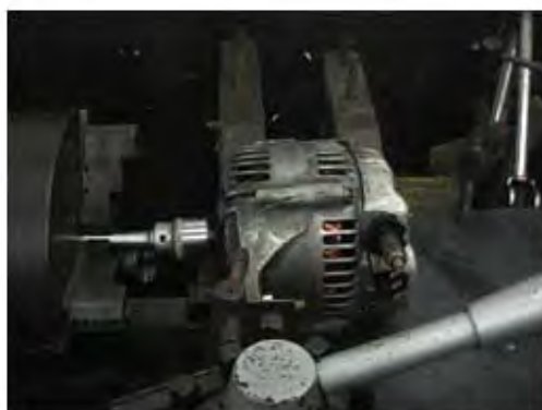
ทดลองให้เครื่องกำเนิดไฟฟ้าหมุนที่ 550 รอบต่อนาที
