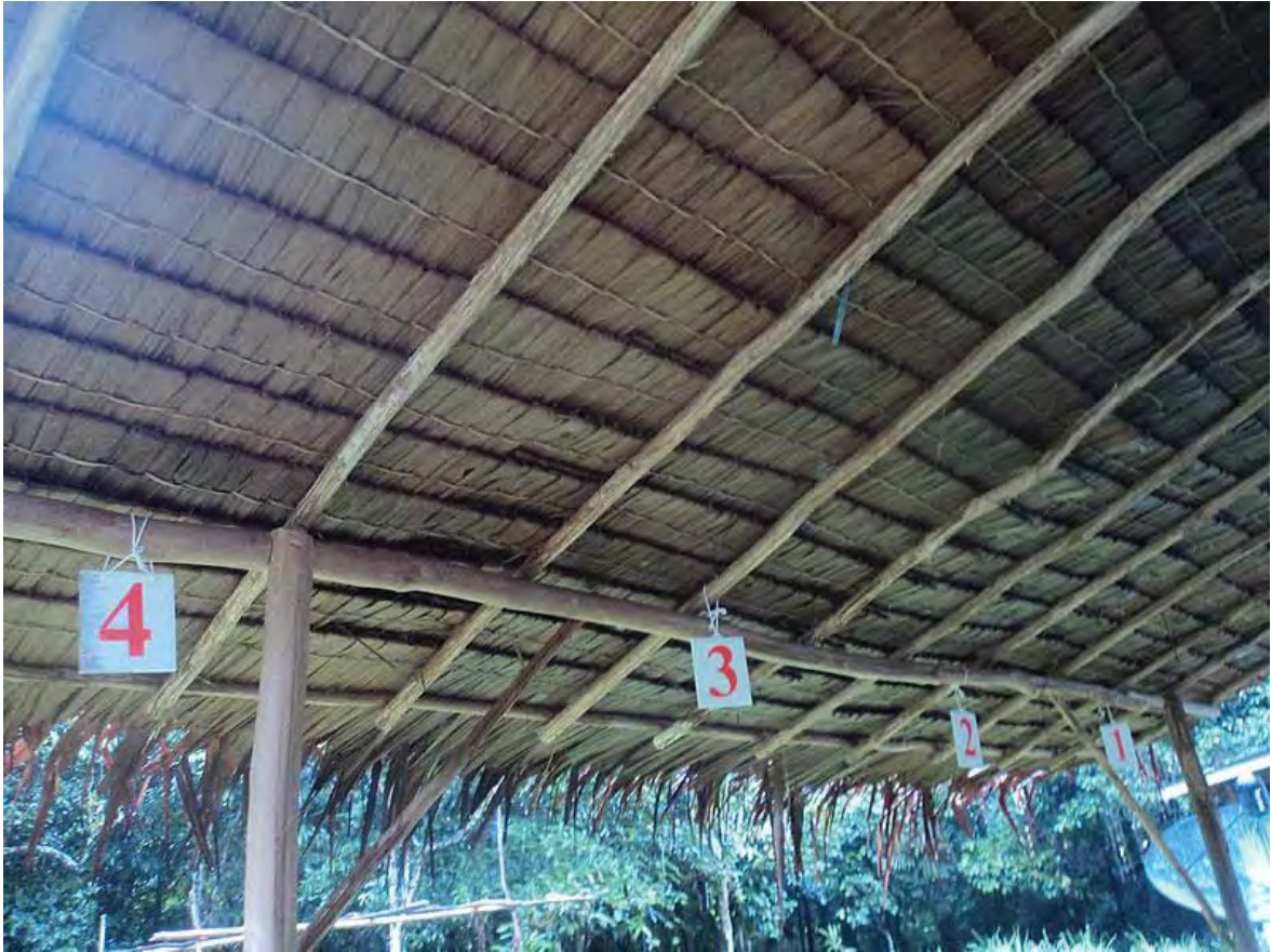
ภาพมุมกว้าง การทดลองมุงหลังคาด้วยตบสาคุเชิงเปรียบเทียบกับ ระหว่าง ตบสาคุทั่วไป ตบสาคุที่ผ่านการแช่น้ำ แช่ดินเหนียว และ แช่สารเคมี
