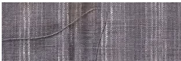
แบบที่ 9 สีเทาอ่อน-เข้มสลับกันวาง เส้นยืนเหมือนตัวอย่าง ฟุ้ง ด้วยไหมอีรี่เส้น ใหญ่
