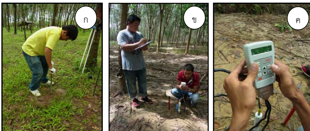
รูปที่ 3.23 การติดตั้ง Access tube เพื่อวัดความชื้นดินโดยใช้เครื่อง Soil profile probe
