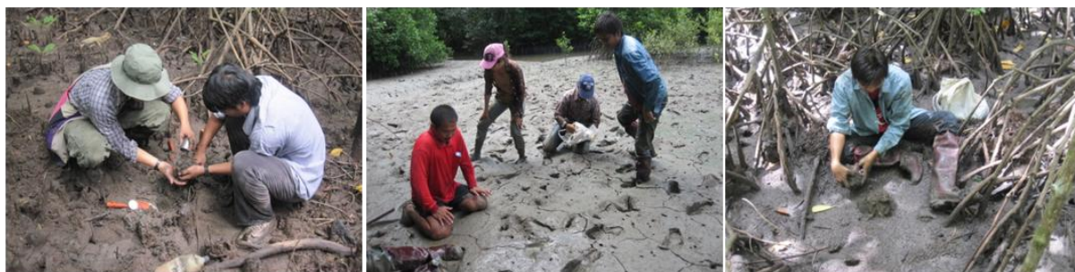
ภาพที่ 5 การเก็บตัวอย่างดิน เพื่อนำมาวิเคราะห์ความหนาแน่นและปริมาณคาร์บอนในดิน
