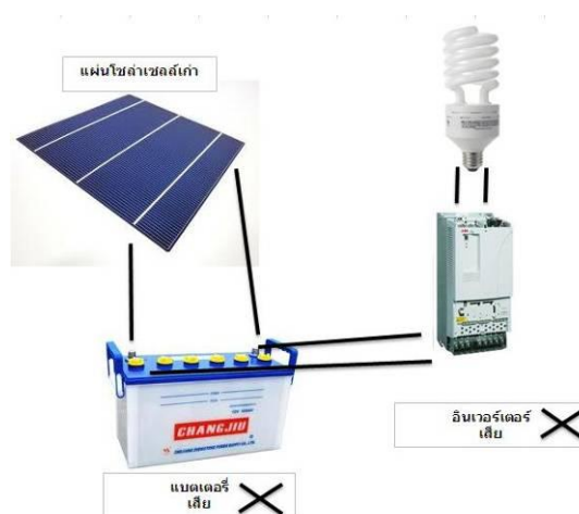
ภาพที่ 3.31 การวิเคราะห์เบื้องต้นว่าชุดอุปกรณ์อินเวอร์เตอร์ เสีย หรือ แบตเตอรี่ เสีย เป็นต้น ทั้งนี้ แผงโซลาเซลล์เก่ายังสามารถใช้งานได้
