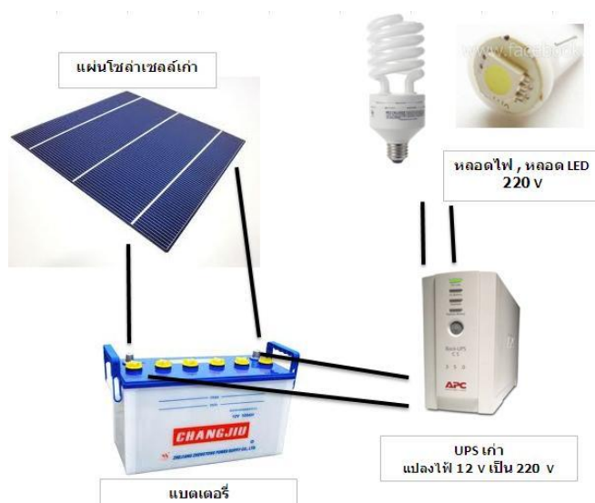
ภาพที่ 3.33 แผ่นโซลาร์เซลล์เก่า ต่อกับเครื่องสำรองไฟ ของคอมพิวเตอร์ UPS เก่า
