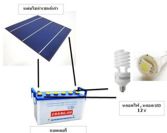
รูปที่ 3.34 แผ่นโซลาร์เซลล์เก่า ต่อกับแบตเตอรี่ 12 โวลต์ และชุดหลอดไฟ 12 โวลต์
