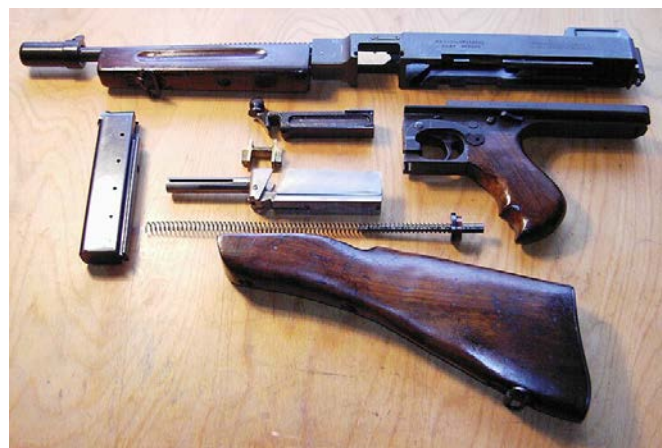
รูปที่ 2.9 ปืนกลมือทอมป์สัน รุ่น M1928A1 (อยู่ในลักษณะถอดชิ้นส่วน)
