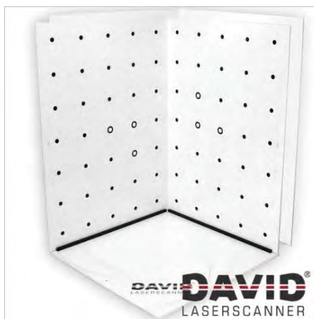
ภาพที่ 5.15 ฉากที่ใช้เป็นมุมในการสอบเทียบ (Calibration Corner) (ที่มา http://www.david-laserscanner.com/ )
