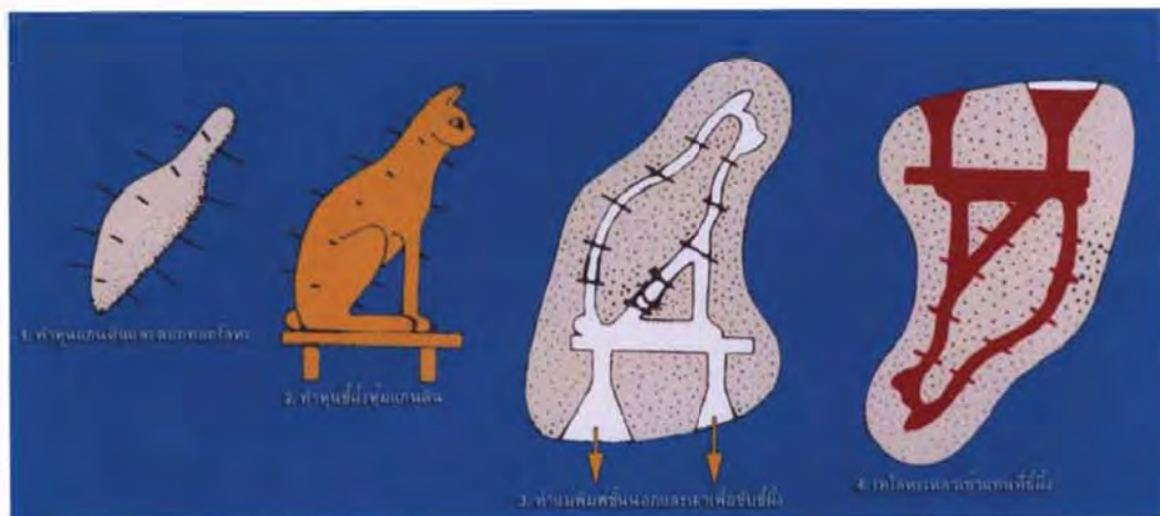
ภาพที่ 1.12 ภาพลายเส้นแสดงขั้นตอนการหล่อประติมากรรมด้วยวิธีการหล่อแบบขี้ผึ้ง
