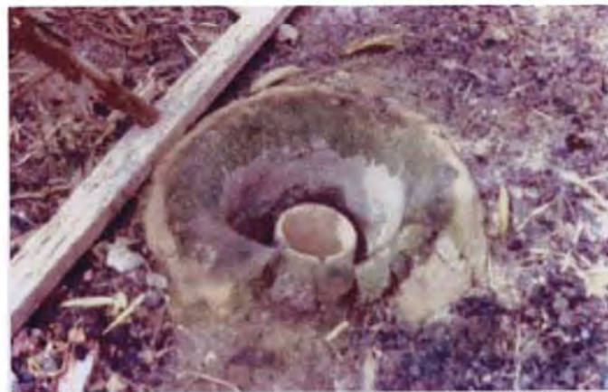
ภาพที่ 3.9 เตาหลอมทองเหลืองแบบดั้งเดิมของชุมชนหัตถกรรมบ้านปะอาว อำเภอเมือง จังหวัดอุบลราชธานี ประกอบด้วยส่วนตัววงเตาและมีเบ้าหลอมทำด้วยดินเผาวางในเตา เป็นไปได้ว่าเตาถลุงทองแดงยุคก่อนประวัติศาสตร์ที่โนนป่าหวายคงมีลักษณะเช่นนี้ ในขณะที่ทำการถลุงทองแดง
