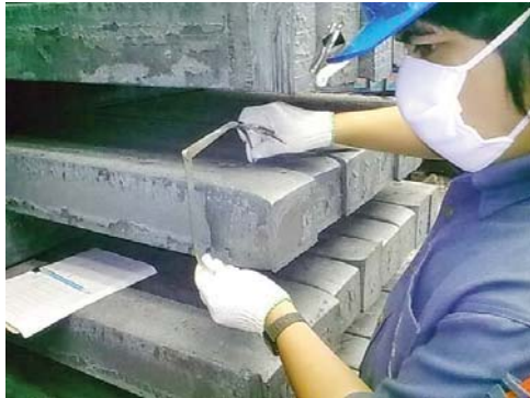
รูปที่ 39 การวัดเพื่อคำนวณหาค่าความบิดเอียงของเหล็กแท่ง
