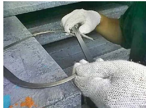
รูปที่ 39 การวัดเพื่อคำนวณหาค่าความบิดเอียงของเหล็กแท่ง
