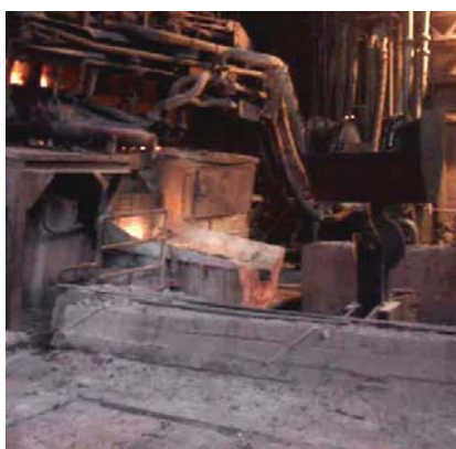
รูปที่ 6 การเทน้ำเหล็กออกจากเตาแบบ Sprout
