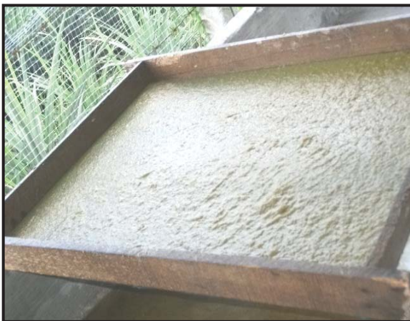
ภาพที่ 4-3 เส้นใยที่เหมาะสมในแบบทำการด้าย(ก)
