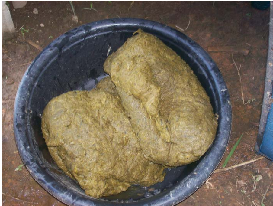
ภาพที่ ก-13 เส้นใยสับปรดหลังการเหยียบ
