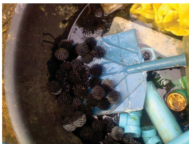
รูปที่ 3.16 ลักษณะตัวกลาง bioball ที่ใช้ในการศึกษา
