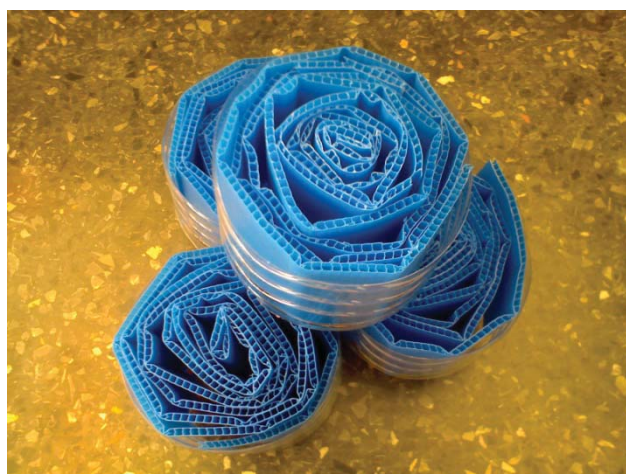
รูปที่ 3.17 ลักษณะตัวกลางพลาสติกที่จัดทำขึ้นเองที่ใช้ในการศึกษา
