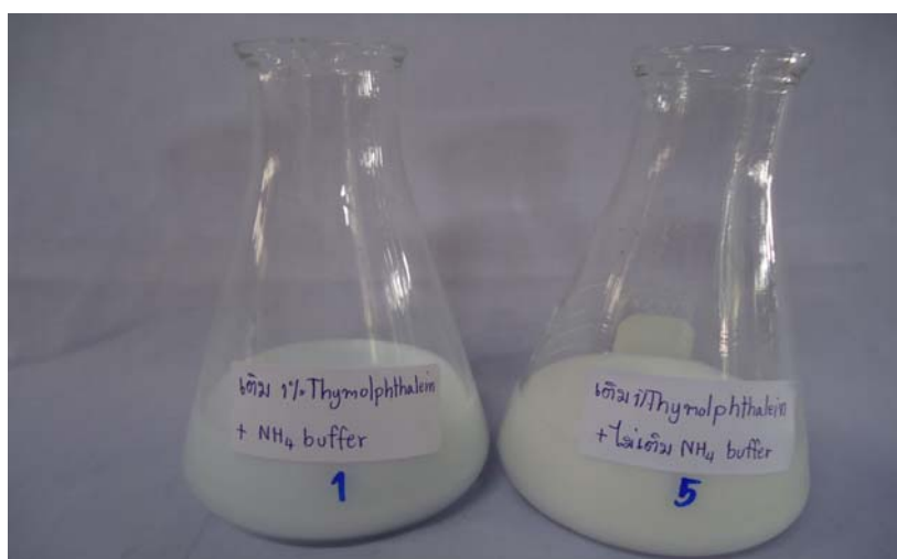
รูปที่ 3.6 สีของตัวอย่างน้ำยางเมื่อเติมสารละลาย 1%Thymolphthalein ร่วมกับแอมโมเนียบัฟเฟอร์ (ซ้าย) และ เมื่อเติมสารละลาย 1%Thymolphthalein โดยไม่มีการเติมแอมโมเนียบัฟเฟอร์ (ขวา)
