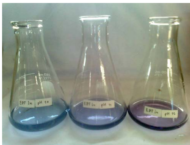
รูปที่ 3.4 สีของอีริโอโครม แบลค ที ในสารละลาย NaOH ที่ pH 10, 11 และ 12 (หรือความเข้มข้น 0.0001, 0.001 และ 0.01 M ตามลำดับ)
