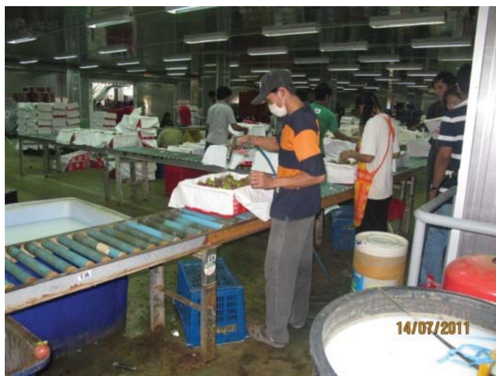
รูปที่ 4.8 การฉีดน้ำยาป้องกันเชื้อรา
