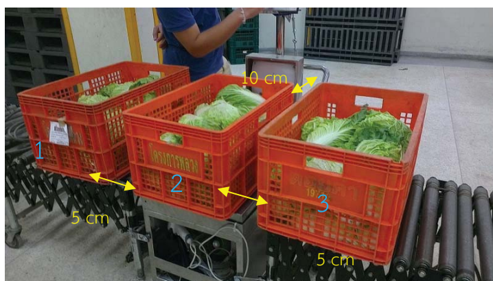
รูปที่ ก.14 การทดสอบเมื่อตะกร้ามีขนาดเท่ากันวางห่างกัน 10 ซม. ห่างจากเครื่องอ่าน 5 ซม. ตะกร้าความสูงปกติ
