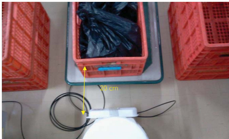
รูปที่ ก.6 การทดสอบเมื่อวางสายอากาศและป้ายอาร์เอฟไอดี อยู่ในระดับเดียวกัน ห่างกันประมาณ 20 ซม
