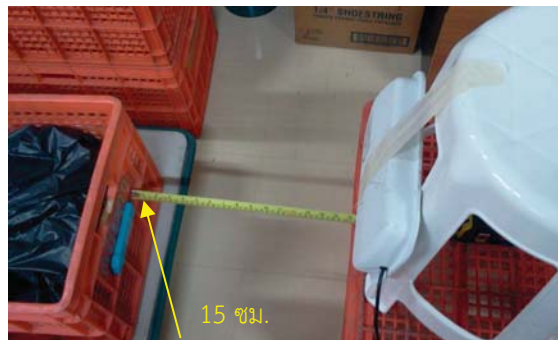
รูปที่ ก.11 การทดสอบเมื่อสายอากาศอยู่สูงกว่าป้ายอาร์เอฟไอดี 15 ซม. ห่างกัน 40 ซม.
