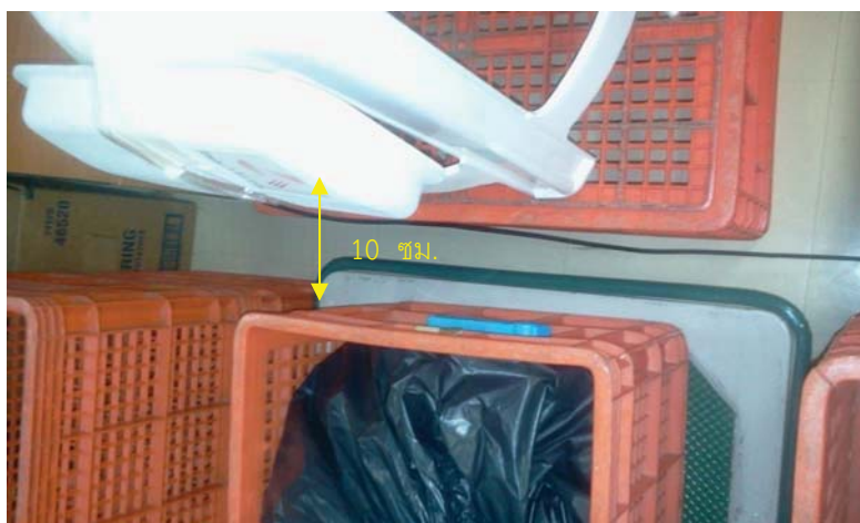
รูปที่ ก.10 การทดสอบเมื่อสายอากาศอยู่สูงกว่าป้ายอาร์เอฟไอดี 25 ซม และห่างกัน 10 ซม
