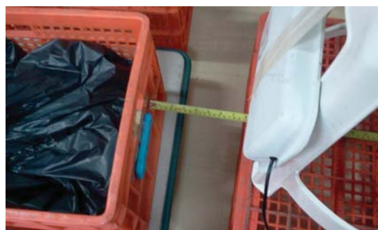
รูปที่ ก.12 การทดสอบเมื่อสายอากาศอยู่สูงกว่า ป้ายอาร์เอฟไอดี 15 ซม. ห่างกัน 20 ซม.
