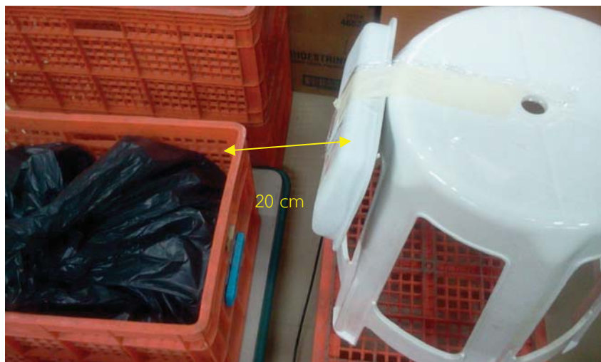
รูปที่ ก.9 การทดสอบเมื่อสายอากาศอยู่สูงกว่าป้ายอาร์เอฟไอดี 25 ซม และห่างกัน 20 ซม
