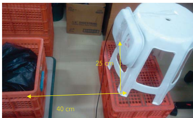
รูปที่ ก.8 การทดสอบเมื่อสายอากาศอยู่สูงกว่าป้ายอาร์เอฟไอดี 25 ซม. และห่างกัน 40 ซม.
