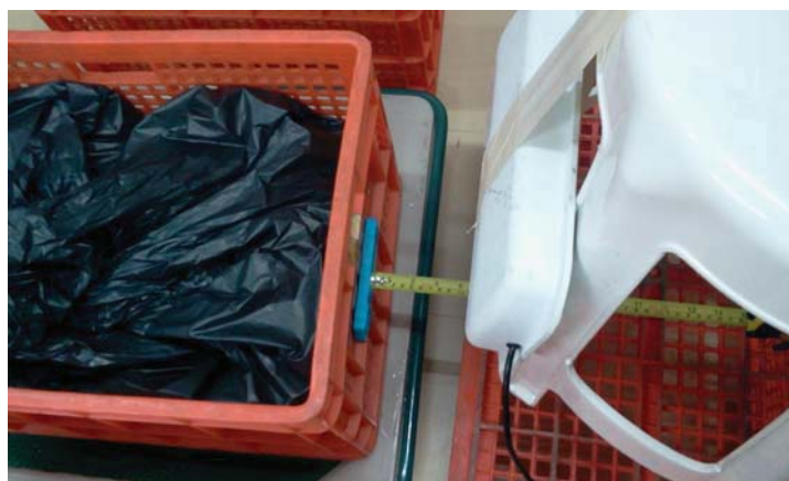
รูปที่ ก.13 การทดสอบเมื่อสายอากาศอยู่สูงกว่า ป้ายอาร์เอฟไอดี 15 ซม. ห่างกัน 10 ซม.
