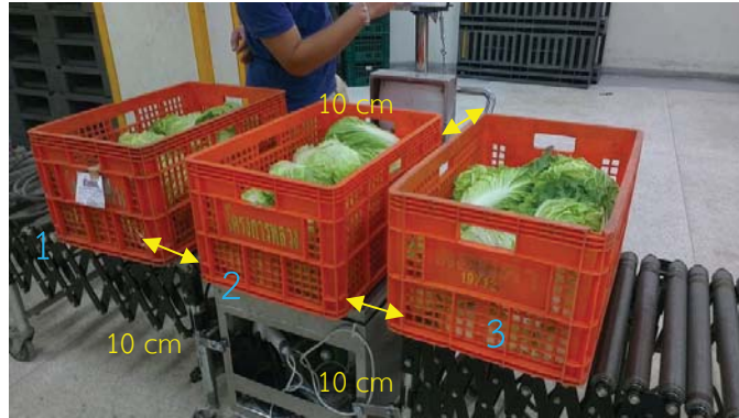
รูปที่ ก.15 การทดสอบเมื่อตะกร้ามีขนาดเท่ากันวางห่างกัน 10 ซม. ห่างจากเครื่องอ่าน 10 ซม. ตะกร้าความสูงปกติ
