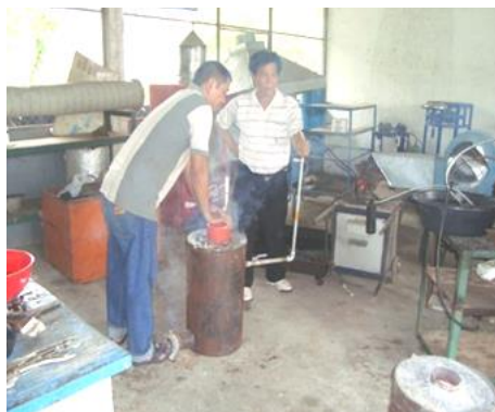
รูปที่ 2 ก. วิธีดับเตาเพื่อเก็บแก๊สตัวอย่าง
