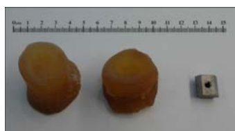
รูปที่ 10 ตัวอย่างยางพาราก่อนถวัลย์และโลหะที่ใช้ทดสอบ
