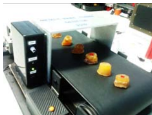
รูปที่ 12 เครื่องตรวจสอบโลหะในยางพาราก่อนถั่วแบบปกติและมีโลหะ
