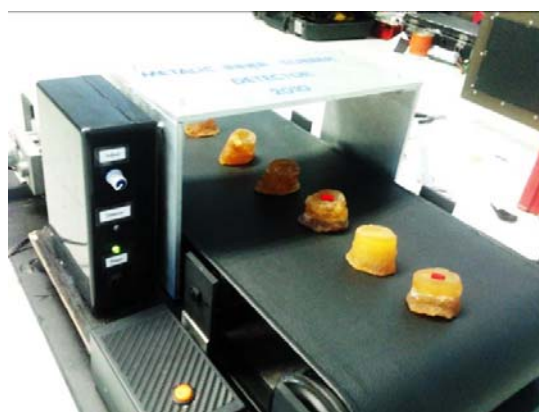
รูปที่ 12 เครื่องตรวจสอบโลหะในยางพาราก้อนด้วยแบบปกติและมีโลหะ
