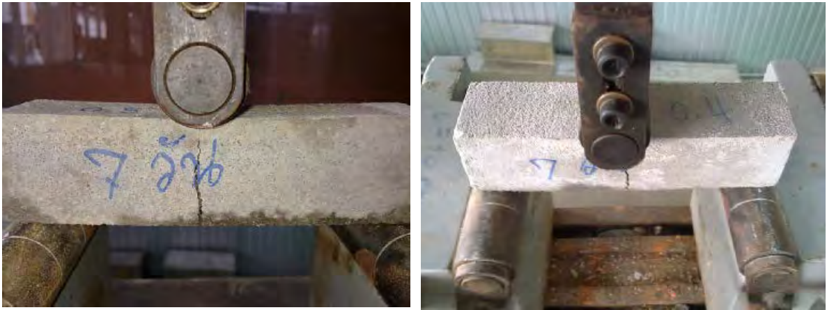
รูปที่ 4.7 การทดสอบกำลังรับแรงดัดของมอร์ต้ามาตรฐานและผสมน้ำยาง
