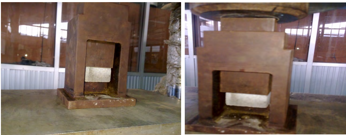
รูปที่ 4.13 การทดสอบการยัดเกาะของมอร์ต้ามาตรฐานและผสมน้ำยาง
