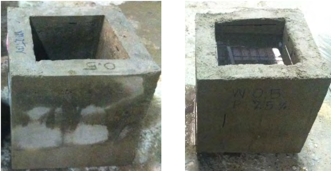
รูป 4.18 แบบจำลองบ่อทดสอบการรั่วซึมของน้ำ
