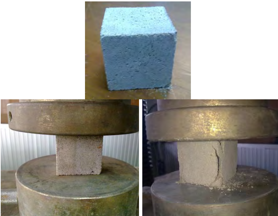
รูปที่ 4.2 การทดสอบหากล้างรับแรงอัดของมอร์ต้ามาตรฐานและผสมน้ำยาง
