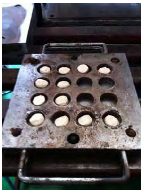
รูปที่ 5 ตัวอย่างรูปทรงกระบอกสำหรับทดสอบการต้านทานแรงกดอัด (Compression set)
