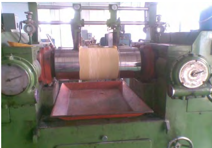
รูปที่ 2 การบดผสมยางในเครื่อง Two-roll mill
