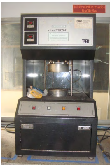
รูปที่ 4 เครื่อง MDR สำหรับวิเคราะห์หาเวลาในการคงรูปของยาง
