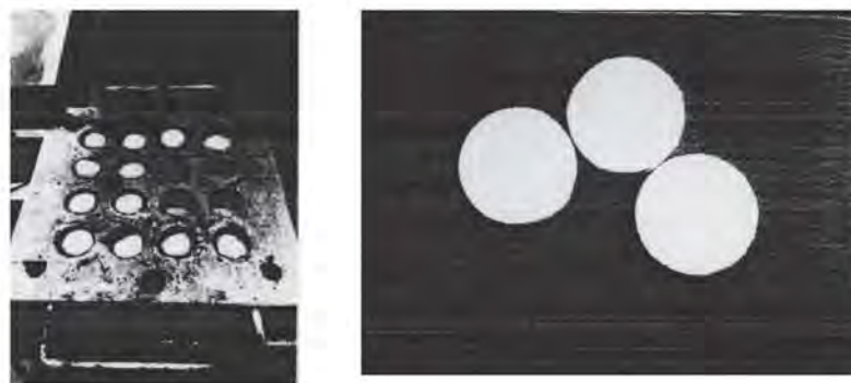
รูปที่ 4 ตัวอย่างรูปทรงกระบอกสำหรับทดสอบการต้านทานแรงกดอัด (Compression set)
