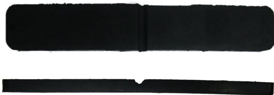
ภาพที่ 9 ชิ้นงานทดสอบอายุความล้าที่ผ่านการขึ้นรูปด้วยแม่พิมพ์
