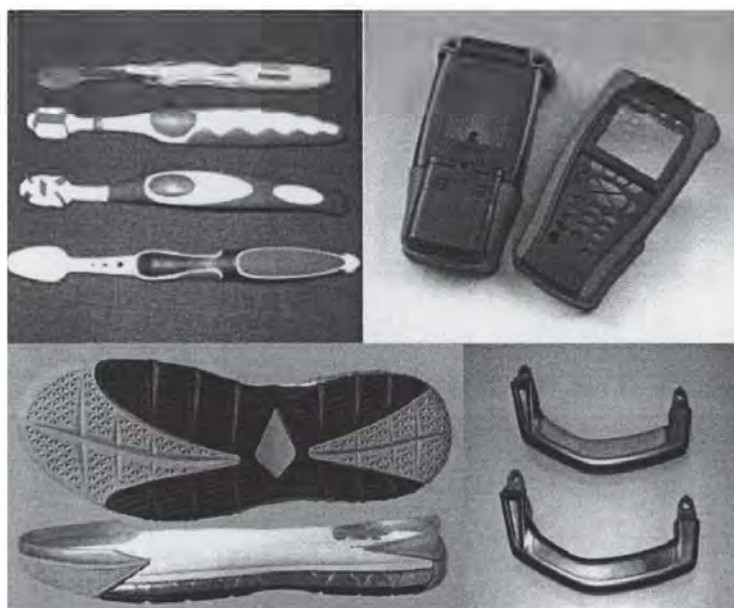
ภาพที่ 1 ตัวอย่างผลิตภัณฑ์ที่ขึ้นรูปด้วยเทคนิคโอเวอร์โมลดิ้ง
