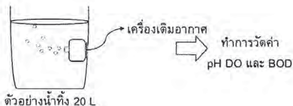
รูปที่ 3 ขั้นตอนการนำบัตน้ำทิ้งโดยวิธีการเติมออกซิเจน
