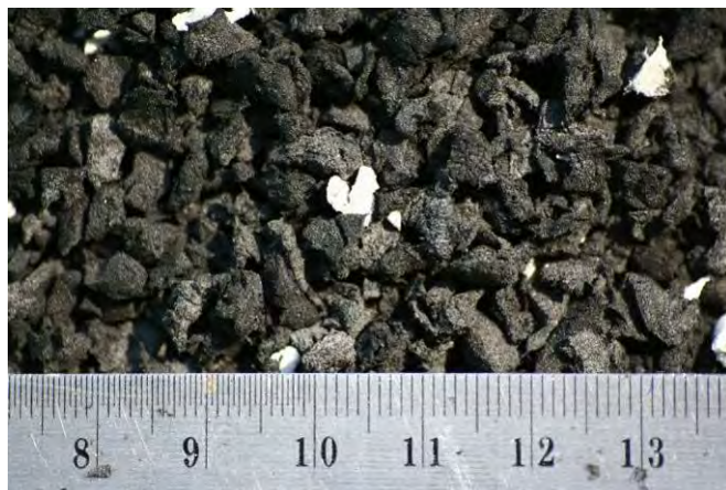
รูปที่ 8 เศษผลิตภัณฑ์พลาสติกอีวีเอที่ย่อยด้วยเครื่องย่อยพลาสติก
