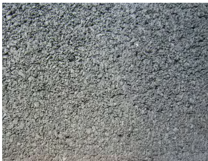
รูปที่ 10 ลักษณะเนื้อของคอนกรีตบล็อกเศษพลาสติกอีวีเอผสมยางวัลคาไนซ์
