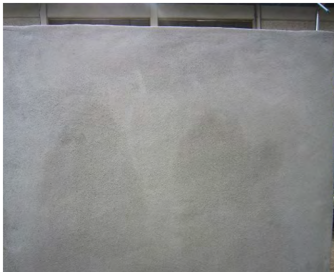
รูปที่ 28 ผลการฉาบผนังที่ก่อจากคอนกรีตบล็อกเศษพลาสติกอีวีเอผสมยางวัลคาไนซ์ด้วยปูนฉาบทั่วไปนาน 3 เดือน
