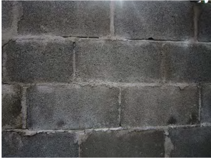
รูปที่ 27 ผลการก่อผนังด้วยคอนกรีตบล็อกเศษพลาสติกอีวีเอผสมยางวัลคาไนซ์เพื่อทดสอบการเสื่อมสภาพนาน 3 เดือน
