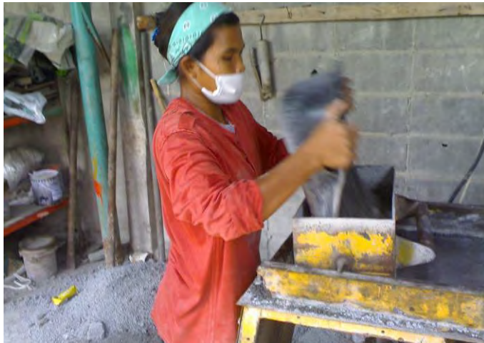
รูปที่ 15 ตัวอย่างการขึ้นรูปคอนกรีตบดด้วยเครื่องอัดไฮโดรลิก
