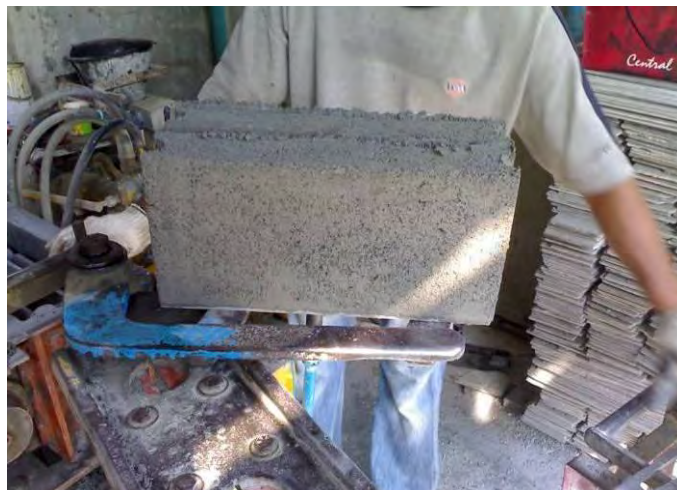
รูปที่ 4 ตัวอย่างคอนกรีตบล็อกที่ได้จากการขึ้นรูปด้วยเครื่องอัดไฮดรอลิก
