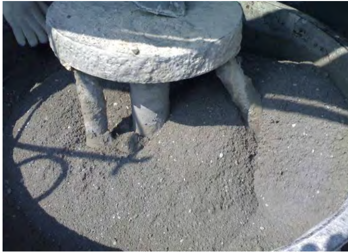
รูปที่ 14 ตัวอย่างการผสมวัตถุดิบของคอนกรีตบดด้วยเครื่องผสมคอนกรีต
