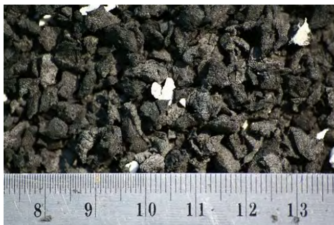
รูปที่ 2 เศษผลิตภัณฑ์พลาสติกอีวีเอที่ย่อยด้วยเครื่องย่อยพลาสติก
