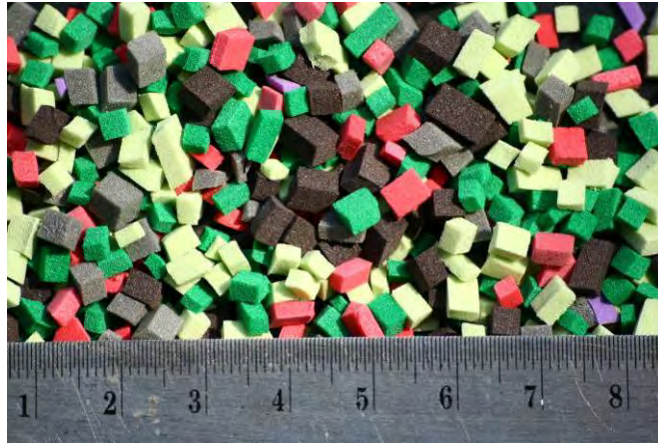
รูปที่ 7 เศษผลิตภัณฑ์พลาสติกอีวีเอที่ย่อยจากการตัดด้วยมีด
