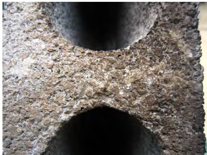
รูปที่ 12 ลักษณะเนื้อของคอนกรีตบล็อกเศษพลาสติกอีวีเอผสมยางวัลคาไนซ์ ภายหลังทดสอบการลามไฟและถูกตีไฟ
