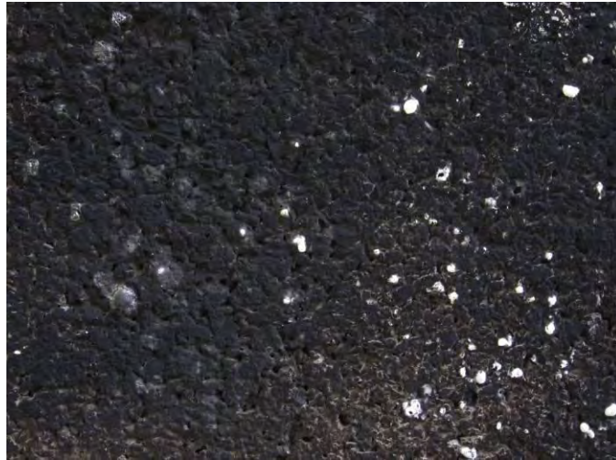
รูปที่ 11 ลักษณะเนื้อของคอนกรีตบล็อกเศษพลาสติกอีวีเอผสมยางวัลคาไนซ์ ภายหลังทดสอบการลามไฟและถูกตีไฟ
