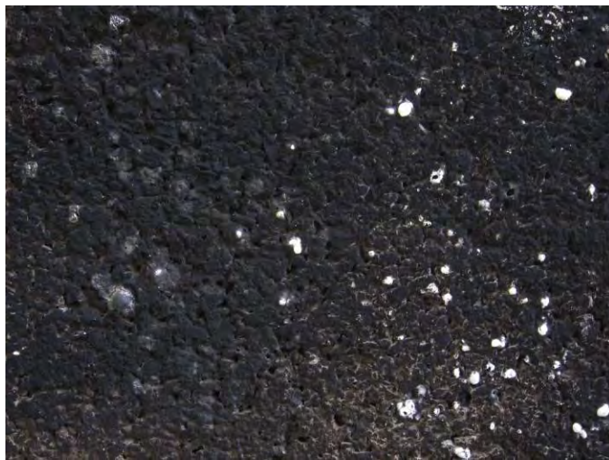
รูปที่ 23 ลักษณะเนื้อของคอนกรีตบล็อกเศษพลาสติกอีวีเอฟสมยางวัลคาไนซ์ภายหลังทดสอบการลามไฟและลุกติดไฟ
