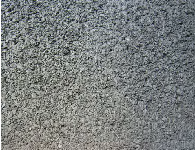
รูปที่ 22 ลักษณะเนื้อของคอนกรีตบล็อกเศษพลาสติกอีวีเอฟสมยางวัลคาไนซ์
