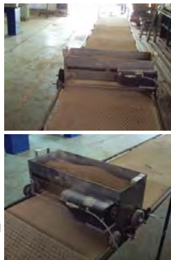
ต้นแบบเครื่องโรยดินสำหรับการเพาะกล้าข้าวนาโยนที่พัฒนาขึ้น
