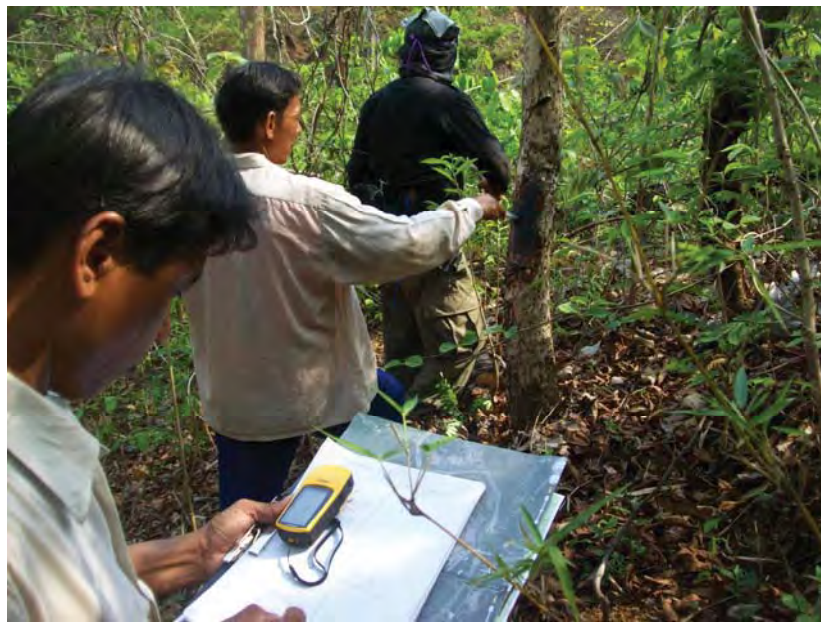
รูปที่ 3.5 การวัดพิกัดสร้างฝาย
