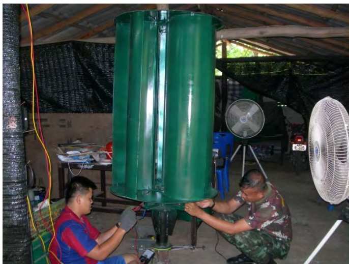
การทดสอบระบบการผลิตไฟฟ้าของกังหันลมแนวตั้ง ณ ศูนย์การเรียนรู้พลังงานทดแทน
