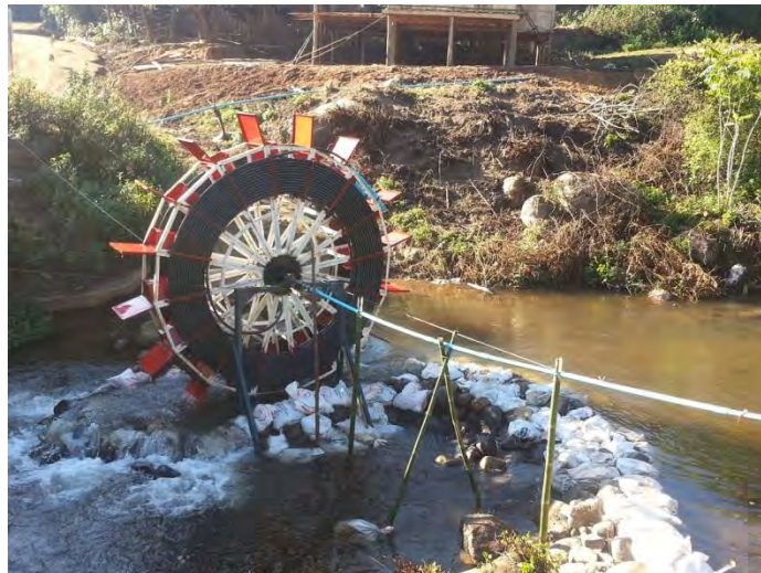
จัดระบบการเคลื่อนที่ของน้ำโดยฝายชลอน้ำ ยกระดับน้ำ เข้าขับเคลื่อนกังหันปั้มน้ำชนิดล้อยน้ำ ที่ประกอบตามตำแหน่งบนฐาน
