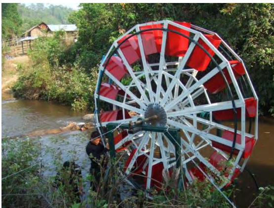
กังหันปั้มน้ำชนิดลื่อน้ำที่ติดตั้งโครงเหล็ก ชั้นส่วนใบกังหัน และสายยางเก็บน้ำ
