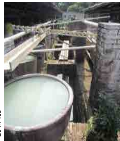
ภาพที่ 4.4 : บ่อพักเศษที่เหลือจากการปั้นหรือส่วนที่ใช้ไม่ได้จะนำไปแช่น้ำหมักส่วนผสมกับวัตถุดิบใหม่เพิ่ม แล้วไปนำเกรอะในอ่างเกรอะดิน เพื่อนำดินกลับมาใช้ใหม่ได้
