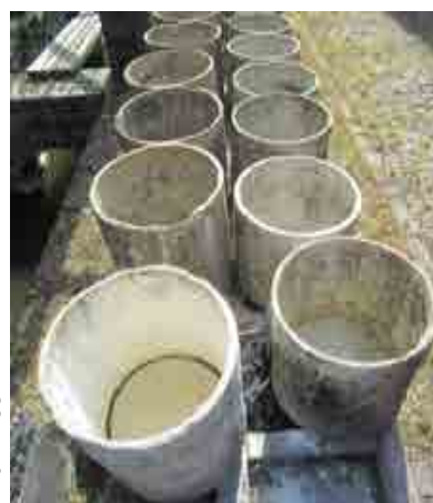
ภาพที่ 4.5 : บ่อเกรอะหรืออ่างเกรอะดิน เพื่อให้น้ำระเหยออกไป แล้วจะได้ดินขาวที่เหนียวพอต่อการนำไปขึ้นรูปที่แป้นหมุนต่อไป
