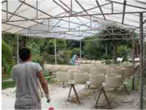
ภาพที่ 5.83 : ในโรงงานผลิต ช่างฝีมือที่ชำนาญงานยังขึ้นรูปและผลิตโดยใช้กระบวนการวิธีแบบดั้งเดิมโดยไม่ฉีดพ่น มีประยุกต์เทคนิคใหม่ๆ บ้าง เช่น การเผางานจะใช้เตาแก๊สที่สร้างด้วยเซรามิกไฟเบอร์ในการเผาชิ้นงาน
