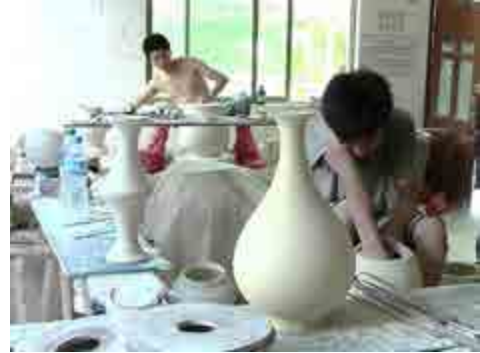
ภาพที่ 5.83 : ในโรงงานผลิต ช่างฝีมือที่ชำนาญงานยังขึ้นรูปและผลิตโดยใช้กระบวนการวิธีแบบดั้งเดิมโดยไม่ฉีดพ่น มีประยุกต์เทคนิคใหม่ๆ บ้าง เช่น การเผางานจะใช้เตาแก๊สที่สร้างด้วยเซรามิกไฟเบอร์ในการเผาชิ้นงาน
