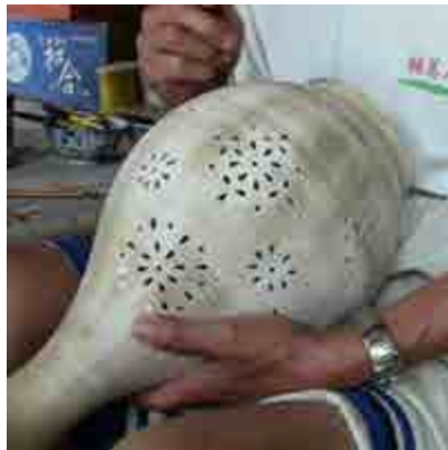
ภาพที่ 5.4 : ส่วนสาธิตการขึ้นรูปหรือผลิตภาชนะเชิงประเพณีเพื่ออนุรักษ์และการตกแต่ง (จวนซี่จั่วฝาง-专器作坊) ในภาพคือเทคนิคการฉลุช่องเพื่ออุดถมด้วยเคลือบของเครื่องกระเบื้องชิงฮัวหลงหลง (青花玲珑)
