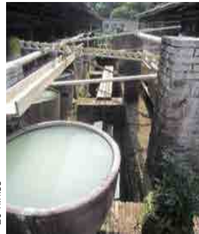
ภาพที่ 4.4 : บ่อพักเศษที่เหลือจากการปั้นหรือส่วนที่ใช้ไม่ได้จะนำไปแช่น้ำหมักส่วนผสมกับ วัตถุดิบใหม่เพิ่ม แล้วไปนำเกรอะในแอ่งเกรอะดิน เพื่อนำดินกลับมาใช้ใหม่ได้
