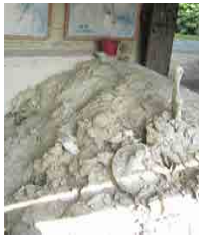
ภาพที่ 4.4 : บ่อพักเศษที่เหลือจากการปั้นหรือส่วนที่ใช้ไม่ได้จะนำไปแช่น้ำหมักส่วนผสมกับ วัตถุดิบใหม่เพิ่ม แล้วไปนำเกรอะในแอ่งเกรอะดิน เพื่อนำดินกลับมาใช้ใหม่ได้
