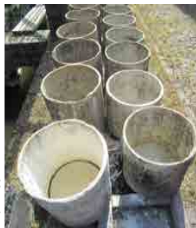
ภาพที่ 4.5 : บ่อเกรอะหรือแอ่งเกรอะดิน เพื่อให้น้ำระเหยออกไป แล้วจะได้ดินขาวที่เหนียว พอดีการนำไปขึ้นรูปที่แป้นหมุนต่อไป
