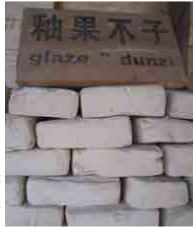
ภาพที่ 4.3 : หลังจากบดและล้างหินพอร์ซเลนแล้วจะนำมาทำเป็นก้อนคล้ายอิฐไว้ เรียกว่า dunzi (หรือ petuntse) ส่วนหนึ่งก็ยังนำไปเป็นส่วนผสมของเคลือบ (glaze) ด้วย
