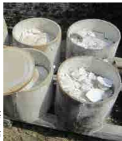
ภาพที่ 4.5 : บ่อเกรอะหรือแอ่งเกรอะดิน เพื่อให้น้ำระเหยออกไป แล้วจะได้ดินขาวที่เหนียว พอดีการนำไปขึ้นรูปที่แป้นหมุนต่อไป
