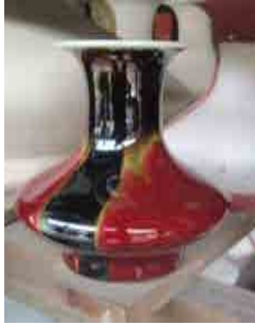
ภาพที่ 5.8 : เครื่องกระเบื้องชิงฮัวหลงฉือ (青花玲珑瓷) และเหยียนเซ่อ ยั่วฉือ (颜色釉瓷) เเผาเคลือบเสร็จเรียบร้อยแล้วที่อุณหภูมิ 1300 องศาเซลเซียส ด้วยกรรมวิธีการเผาในเตาเผาแบบประเพณีดั้งเดิมตามขั้นตอนทุกประการ
