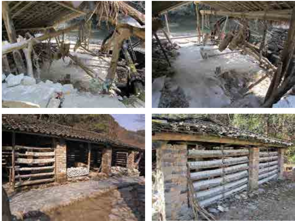
ภาพที่ 5.38 : ครกกระเดื่องน้ำ (Shuidui) ใช้การไหลของน้ำเป็นพลังงานกลในการบดย่อยหิน พอร์ชเลนและนำมาล้างและเกรอะตามบ่อชุดเพื่อเตรียมจัดให้เป็นก้อนสี่เหลี่ยมแล้วนำส่งไปยัง โรงงานในเมือง ส่วนนี้ใช้เป็นกิจกรรมสาธิตตามแบบอย่างดั้งเดิม นอกจากนี้จะเป็นแหล่งเตรียม วัตถุดิบสำคัญแล้วยังเป็นแหล่งผลิตและแหล่งเตามังกรโบราณอีกด้วย
