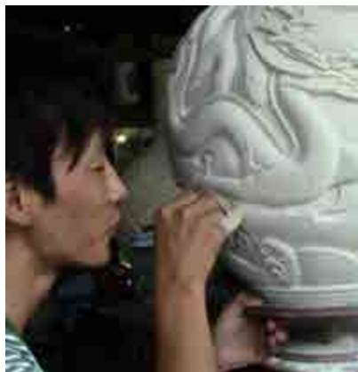
ภาพที่ 5.5 : ส่วนสาธิตการขึ้นรูปหรือผลิตภาชนะเชิงประเพณีเพื่ออนุรักษ์และการตกแต่ง ในภาพคือเทคนิคการแกะสลักภาชนะดินดิบที่แห้งแล้ว (Greenware) แต่ยังไม่ได้เผาในงานเครื่องกระเบื้องเตียวซู่ฉือ (雕塑瓷)
