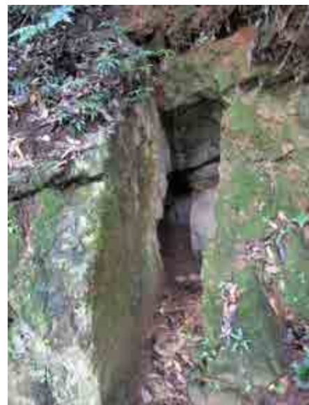
ภาพที่ 5.31 : ช่องอุโมงค์เก่าที่เจาะจากรอยแตกของหิน เจาะช่องเข้าไปเป็นช่องสามเหลี่ยม เมื่อพบว่าตรงจุดไหนมีแร่เกาลินมากจะทำการเปิดหน้าเหมืองออกเป็นบริเวณกว้าง ตำแหน่งเจาะช่องหินต่างๆ ได้พัฒนาเป็นแหล่งศึกษาและเรียนรู้ โดยมีป้ายนิทรรศน์แสดงข้อมูลอยู่ทุกจุด
