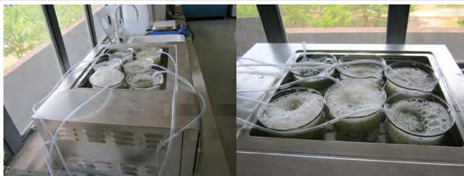
ภาพที่ 3.5 ลักษณะของระบบบำบัดน้ำทิ้งบ่อกักโดยใช้ถังแบบแบตเตอรี่ในการทดลองในห้องปฏิบัติการขณะใส่น้ำอ่างน้ำควบคุมอุณหภูมิ (water bath)
