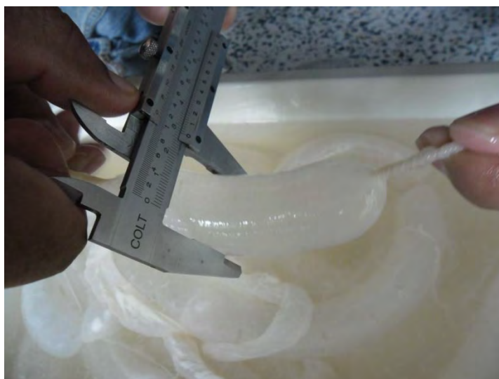
ภาพที่ 11 การวัดเส้นผ่านศูนย์กลางของไส้ โดยใส่น้ำในไส้โคให้เต็มความจุของไส้ มัดไส้โคที่ใส่น้ำทั้งสองด้าน แล้ววัดด้วยเวอร์เนียคาลิเปอร์
