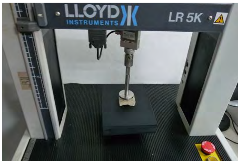
ภาพที่ 17 หัววัดแบบกด (TPA) ของเครื่อง Instron Universal Testing Machine
