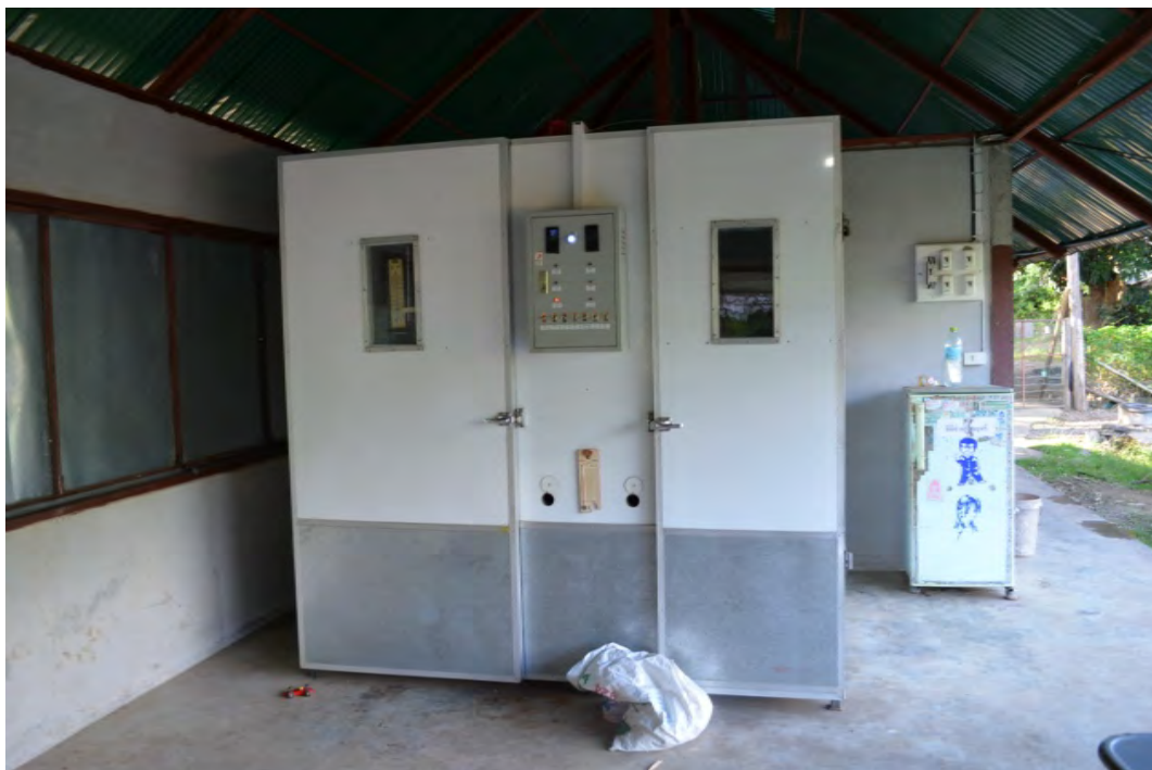
ภาพที่ ข-3 ตู้ฟักไข่ขนาด 4,500 ฟอง ผลิตลูกไก่เพื่อจำหน่ายให้แก่เกษตรกรในโครงการ
